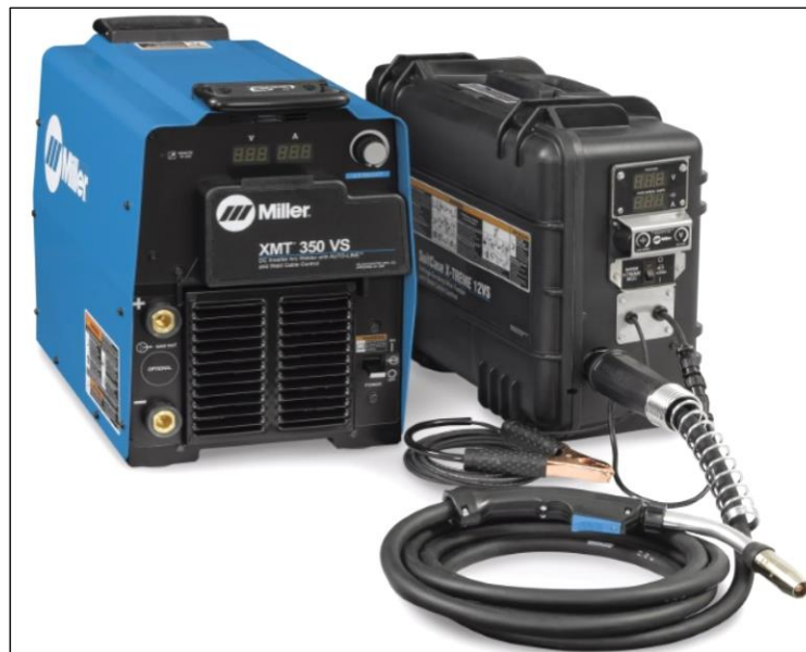
Figura 288. Máquina de soldar, maletín de porta aporte, proceso Fcaw.
