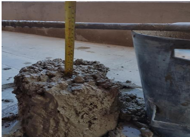
Muestra de relación agua cemento (A/C = 0.69)
