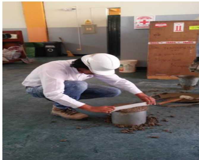
Enrasado final con regla metálica
