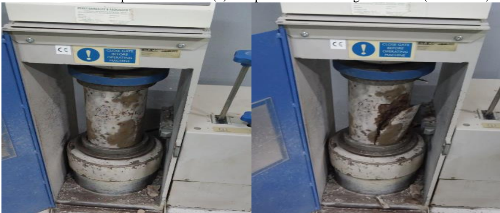
Resistencia a la compresión a los veintiocho (28) días para una relación agua cemento ( A/C = 0.75 )
