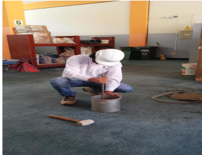
Compactación con varilla metálica
