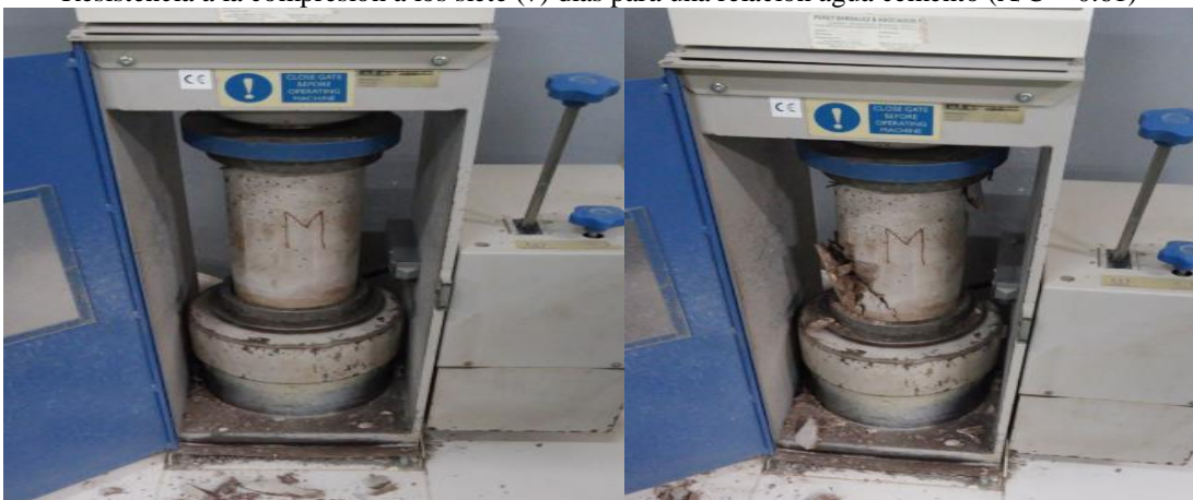
Resistencia a la compresión a los veintiocho (28) días para una relación agua cemento ( A/C = 0.61 )
