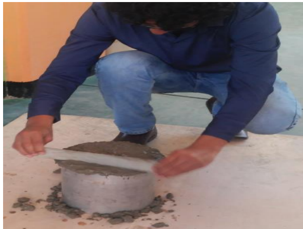
Enrasado final con regla metálica
