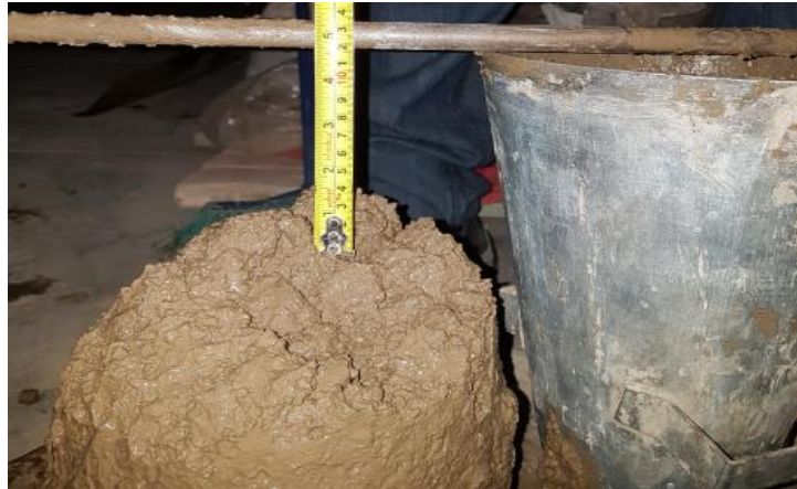
Muestra de relación agua cemento (A/C = 0.61)
