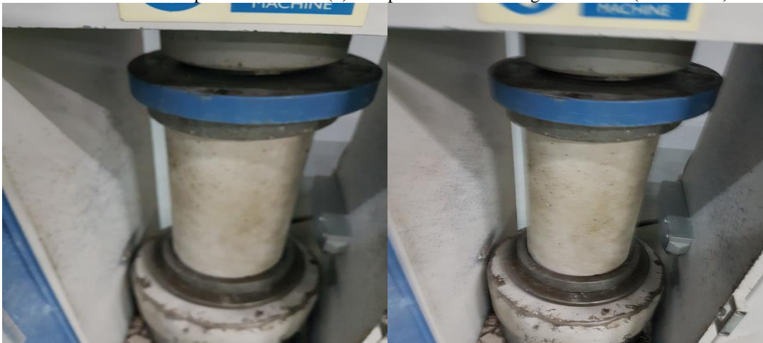
Resistencia a la compresión a los siete (7) días para una relación agua cemento ( A/C = 0.61 )
