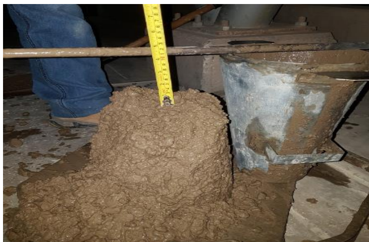
Muestra de relación agua cemento (A/C = 0.75)
