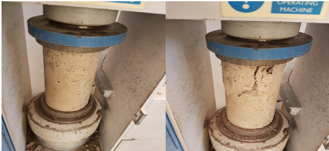
Resistencia a la compresión a los tres (3) días para una relación agua cemento ( A/C = 0.61 )
