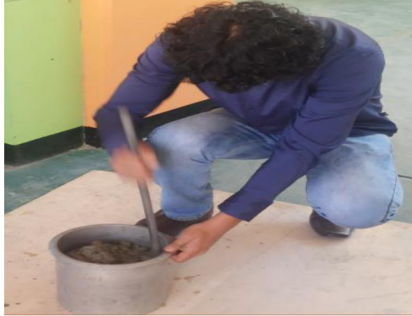
Compactación con varilla metálica
