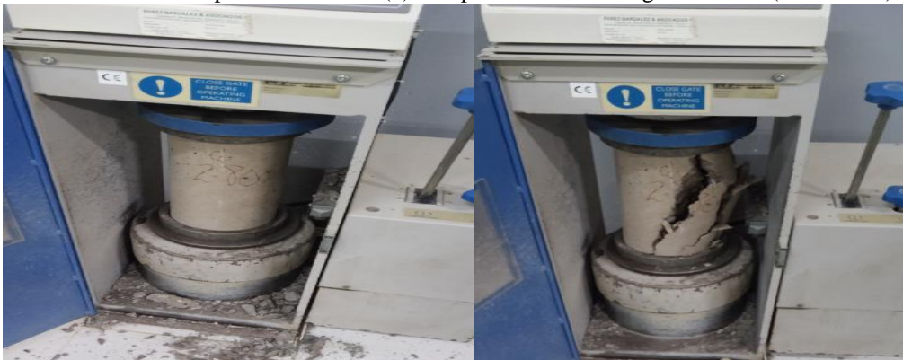
Resistencia a la compresión a los veintiocho (28) días para una relación agua cemento ( A/C = 0.69 )
