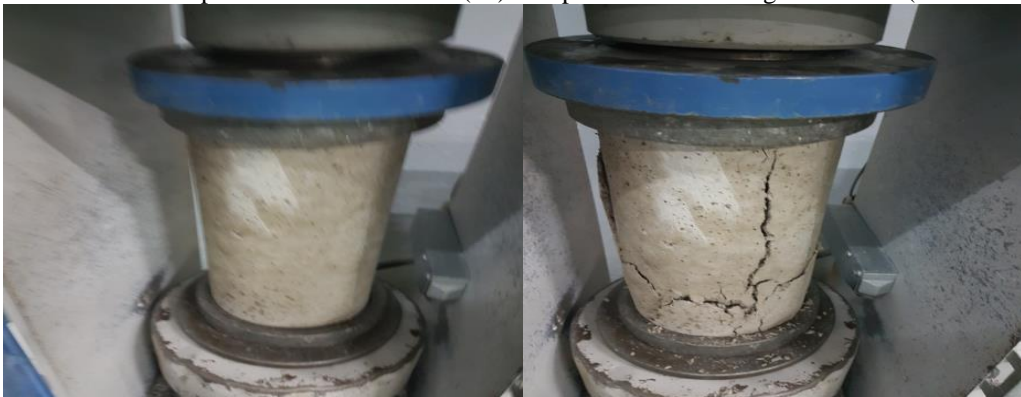
Resistencia a la compresión a los tres (3) días para una relación agua cemento ( A/C = 0.75 )
