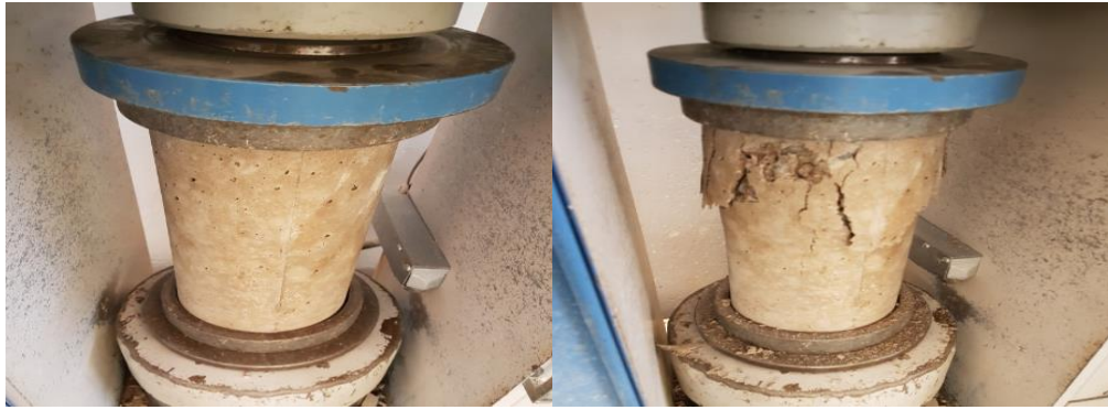
Resistencia a la compresión a los tres (3) días para una relación agua cemento ( A/C = 0.69 )
