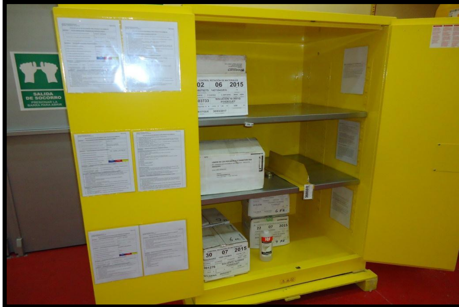
Figura 45. Interior del gabinete para productos inflamables
