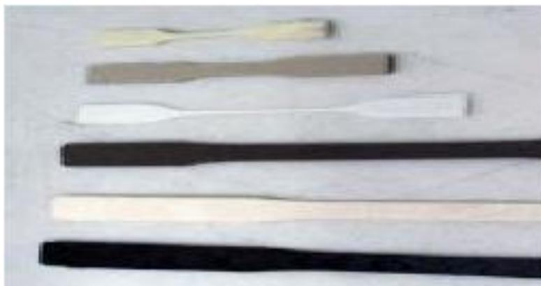
Figura 5: TIPOS DE PROBETA
