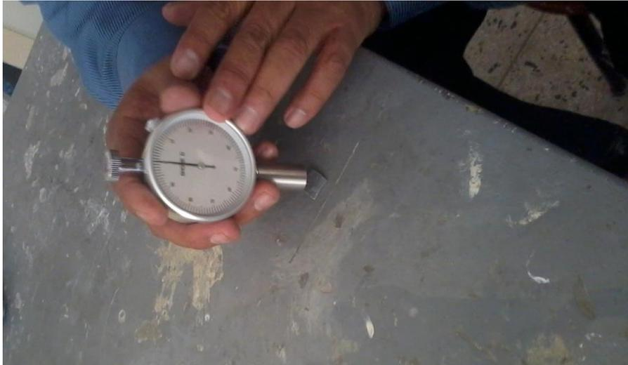
*Figura 33: ENSAYO DE DUREZA*
