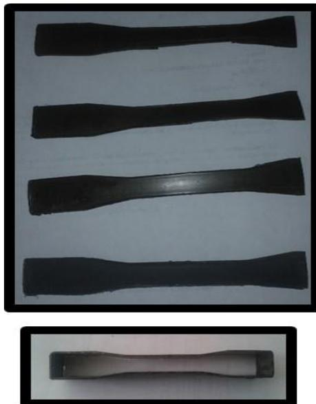
*Figura 28: CORTE DE PROBETAS*
