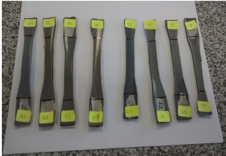
*Figura 30 : PROBETAS EXPUESTAS A RADIACION UV*
