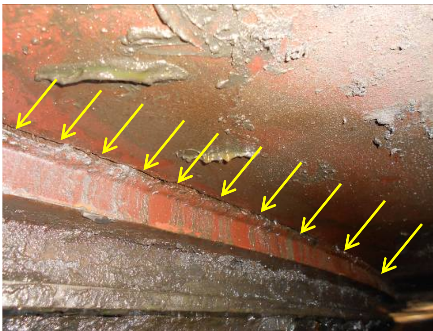
(а) простирање пукотине дуж контуре ослонца радиаксијалног лежаја
