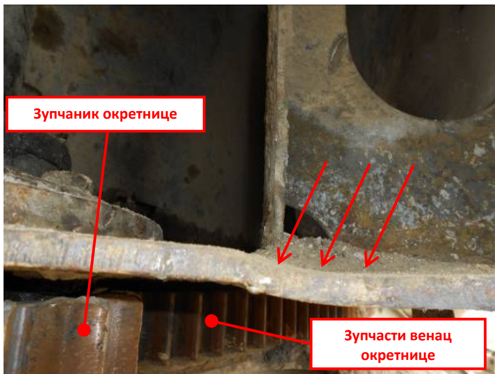
(б) пластичне деформације доње плоче
