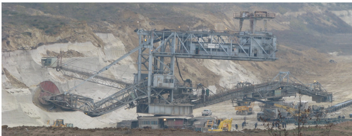
Слика 1. Багер SRs 1200x24/4x4+VR (G - 3) након хаварије 06.11. 2012.
