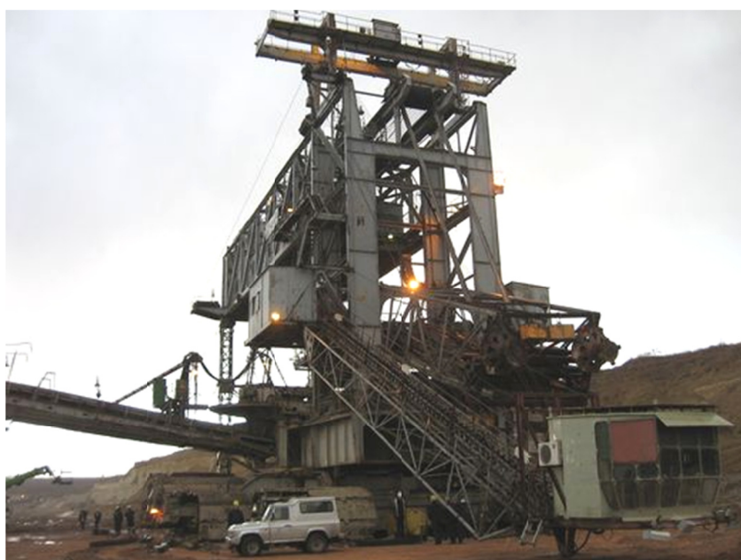
Слика 4. Багер на ремонтном плацу, након окретања горње градње
