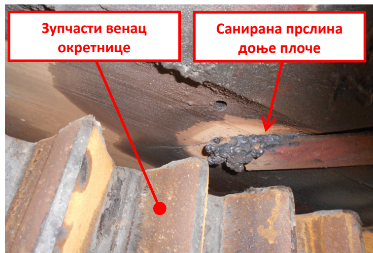
Слика 8. Санациона прслина доње плоче, поглед одоздо
