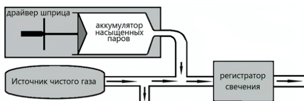
Рис. 4. Схема генератора паров для создания газовой смеси с малой концентрацией нитробензола
