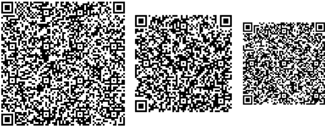
Slika 26: Razine oštećenja QR kodova
