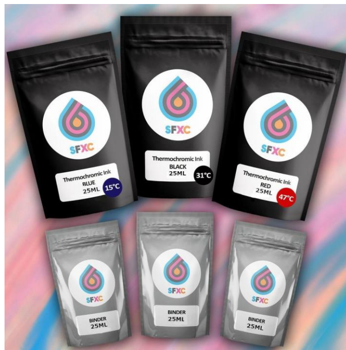
Slika 13: Termokromne boje koje su korištene za eksperimentalni dio [16]
