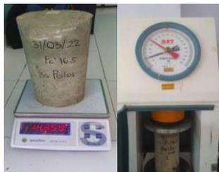
Gambar 3. Timbang dan Uji Kuat Tekan Silinder Beton
