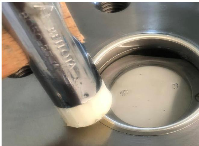
**Figura 8.3.** Colocando junta plana superior con ayuda del martillo de nylon.
