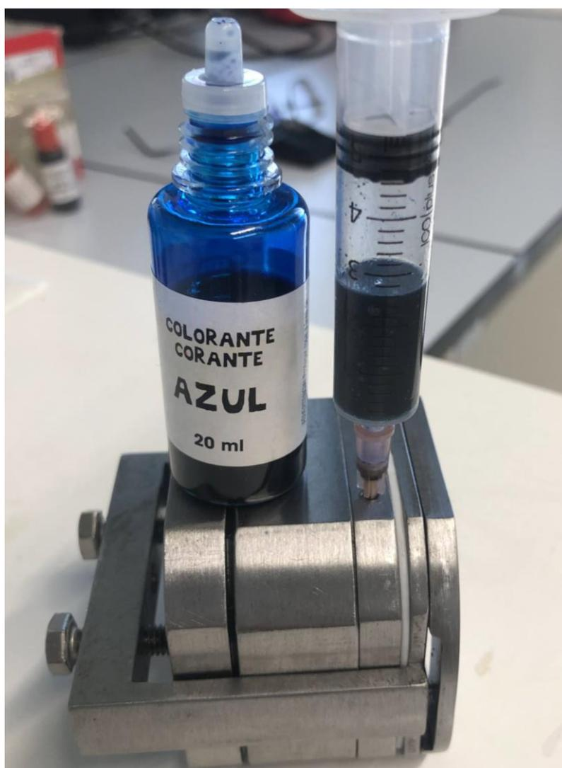
**Figura 7.10.** Insertando colorante en compartimiento de la muestra.
