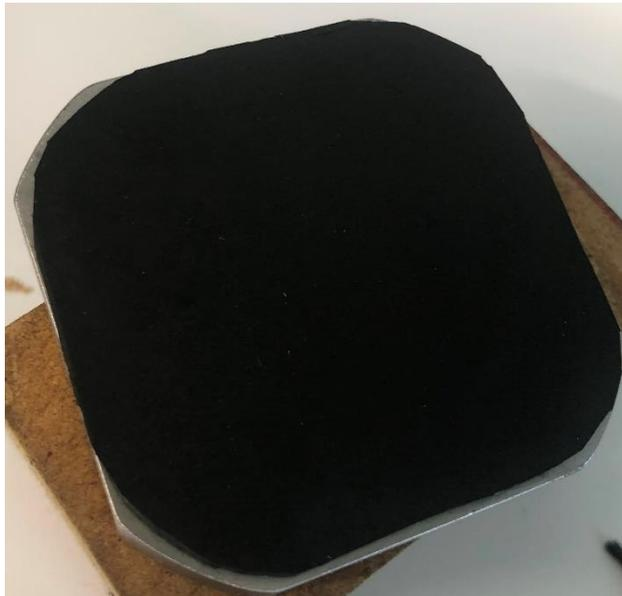
**Figura 7.5.** Junta caucho.
