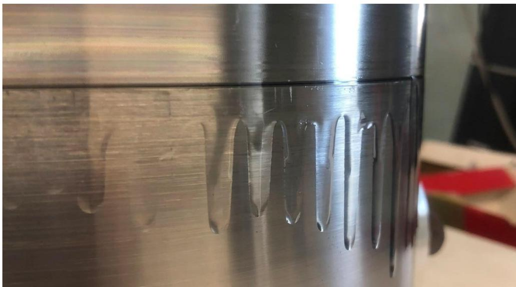
**Figura 3.7.** Consecuencia de par de apriete en tapa insuficiente.
