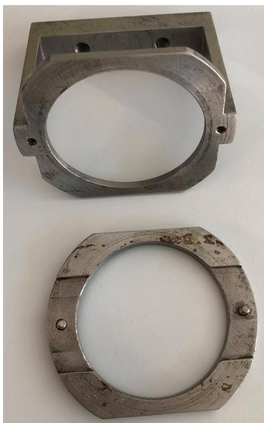
**Figura 7.2.** Soporte celda y base inferior.
