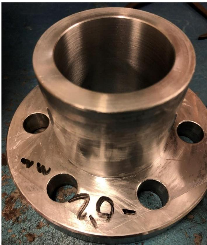
**Figura 2.3.** Soportes de ventanas en el taller para rebaje de 0.25 mm.
