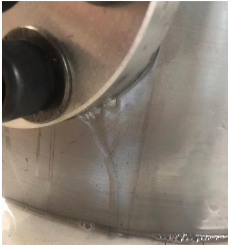
**Figura 3.8.** Consecuencia de par de apriete en ventanas insuficiente.
