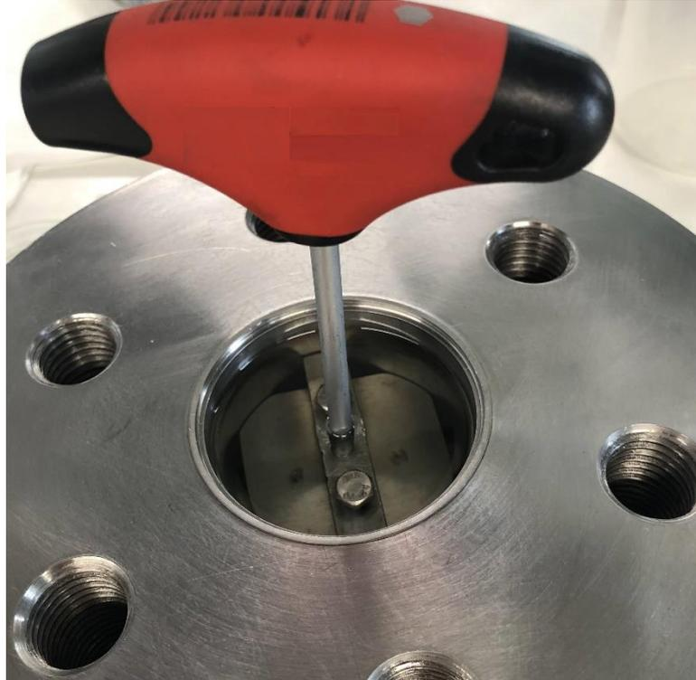
**Figura 7.8.** Herramienta insertar/extraer celda interior.
