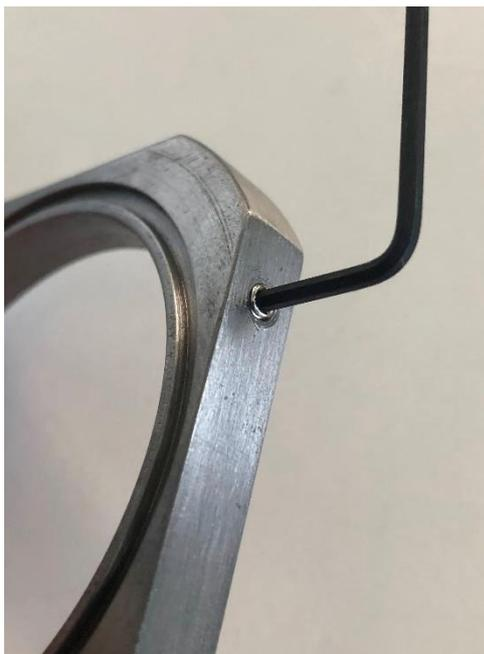
**Figura 7.3.** Compartimento con tornillo allen ciego.
