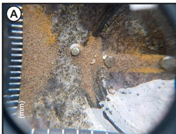
Figura 3. Características físicas do ouro liberado, ilustrando: em A) cone do fundo da bateia com ouro visível.
