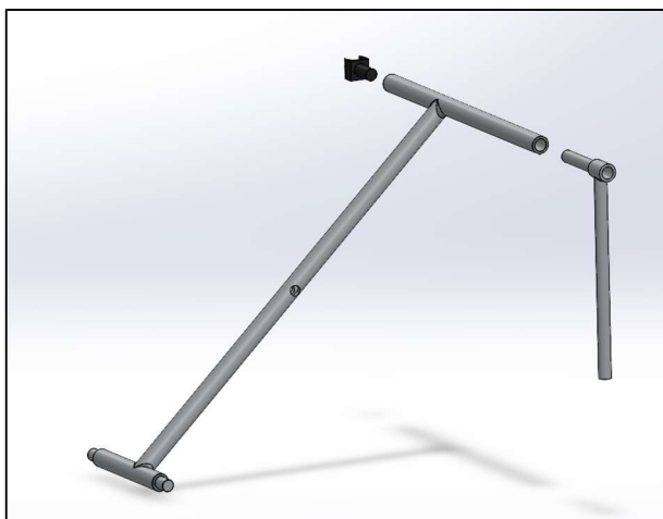
Figura 4.4 Les tres peces que formen el xassís mòbil (Font: Pròpia)
