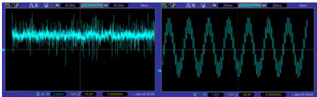
Fig. 8. Izquierda: Suma de las señales, señal de entrada al electrodo que corresponde a 100 \mu\text{V} más ruido. Derecha: señal de salida del electrodo, con un offset de 2,5 V y una amplitud de 2,5 V.
