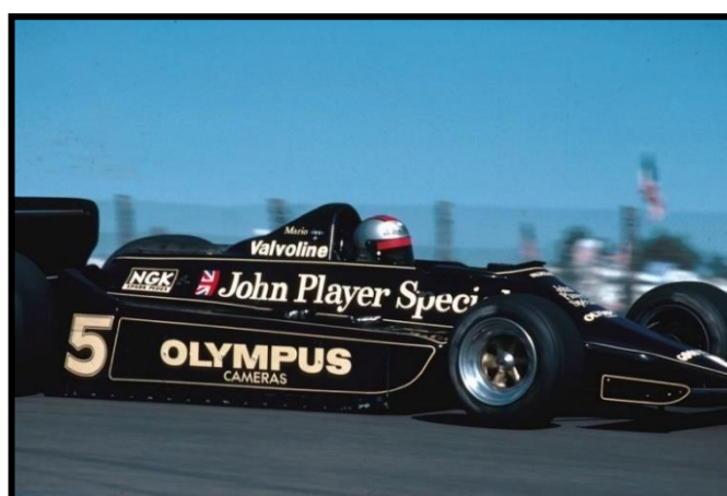
Figura 25. Lotus 79 y el primer coche en implementar el efecto suelo. (Fuente: Motorsport Magazine)
