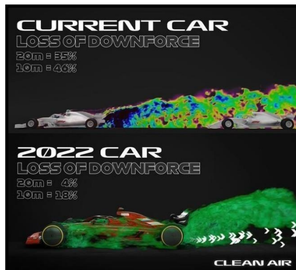
Figura 47. Comparativa de la pérdida de carga aerodinámica de un coche perseguidor a 20 y 10 m. Arriba coche de 2021; abajo coche de 2022. (Fuente: Formula 1)
