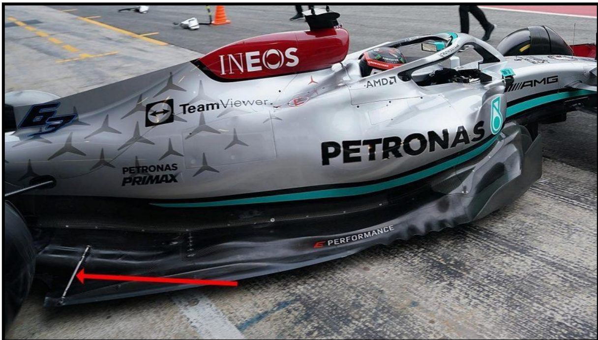
Figura 59. Tirantes en el Mercedes para inhibir la flexibilidad del suelo ante el rebote. (Fuente: Formula 1)
