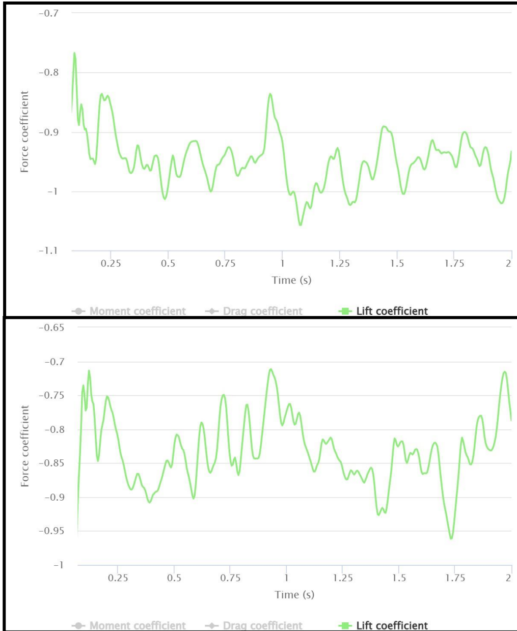
Figura 97. Variación en el tiempo del coeficiente de sustentación en coche alto (arriba) y coche bajo (abajo).
