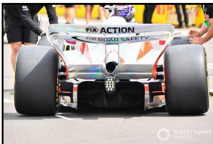
Figura 53. Difusor especificación de 2022. (Fuente: Motorsport)
