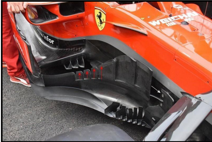
Figura 20. Bargeboards que desvían los vórtices a puntos claves de la carrocería. (Fuente: RaceFans)
