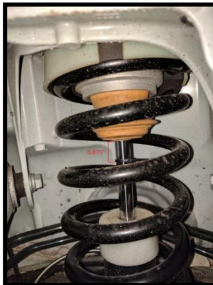
Figura 45. Suspensión de un vehículo con tope de goma al final de su recorrido (no se trata de una suspensión de un F1). (Fuente: Emd Auto)
