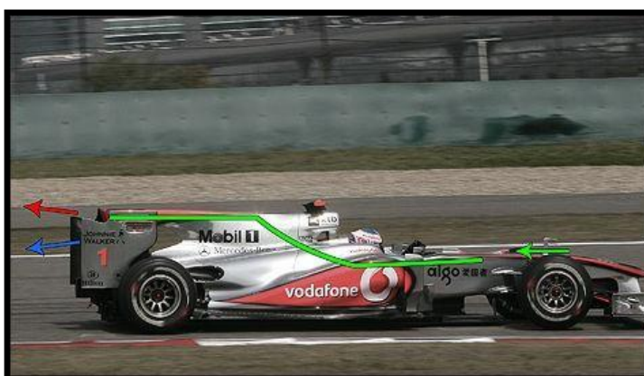
Figura 31. Representación del funcionamiento del F-Duct de McLaren en 2011. (Fuente: auto123)
