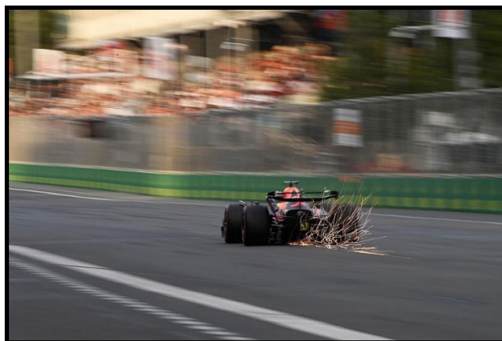
Figura 57. Red Bull experimentando marsopeo en la recta de Bakú. (Fuente: Motorsport)
