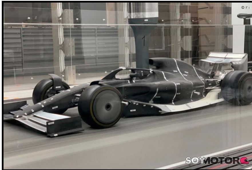
Figura 56. Maqueta de especificación de 2022 siendo testada en un túnel de viento. (Fuente: Soy Motor)
