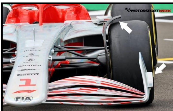
Figura 50. Nuevo concepto de alerón delantero de 2022, con flechas señalando las cubiertas de las ruedas y los nuevos endplates. (Fuente: Motorsport week)
