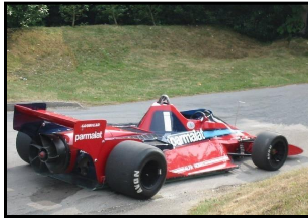
Figura 26. Concepto de difusor autoventilador de Brabham BT46. (Fuente: Wikipedia)
