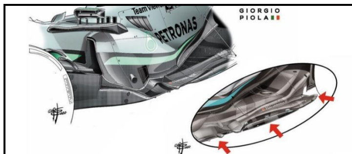
Figura 66. Mejoras en el suelo de Mercedes con perfil interior ligeramente más elevado que el exterior. (Fuente [51])
