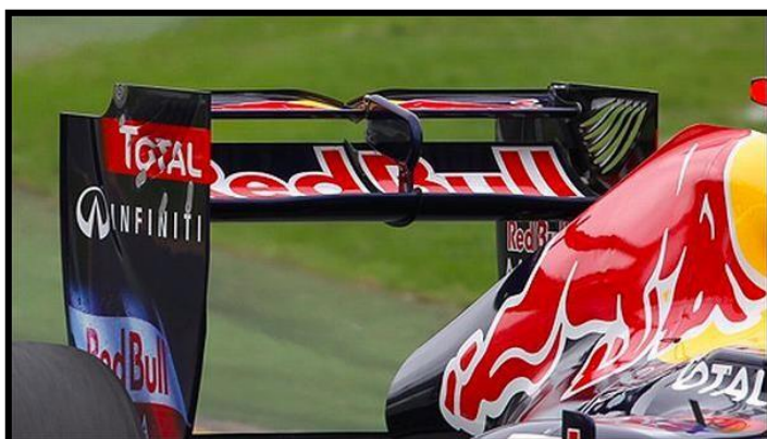
Figura 33. DRS abierto en Red Bull. (Fuente: Car and driver)
