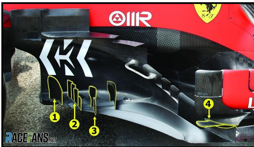
Figura 21. Bargeboards con función de generador de vórtices. (Fuente: RaceFans)
