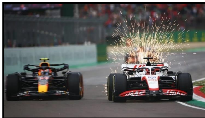
Figura 34. Rebote en el Hass en plena recta. (Fuente: Formula1)
