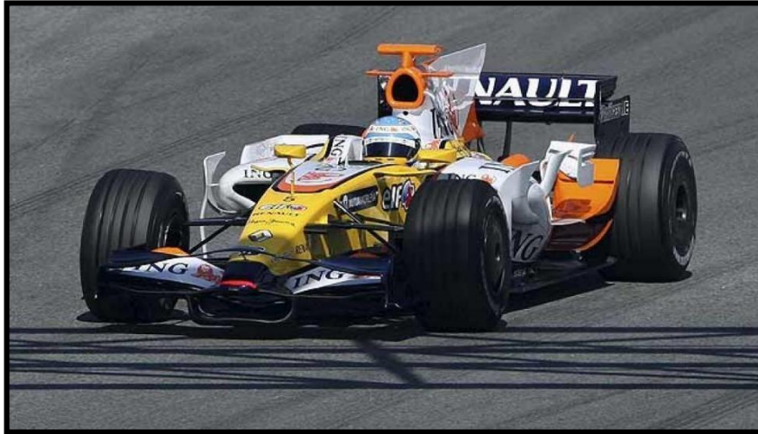
Figura 28. Renault 2008 con múltiples apéndices aerodinámicos. (Fuente: Eurosport)
