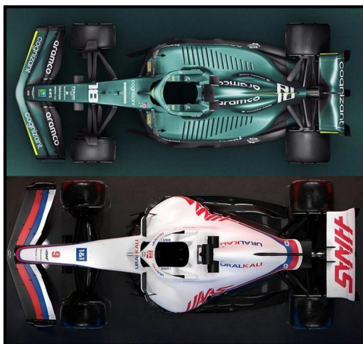
Figura 61. Aston Martin (arriba) con radiadores más atrasados y ensanchamiento final más abrupto; Hass (abajo) con radiadores más adelantados y con forma de gota al disponer de más espacio. (Fuente: Formula 1)
