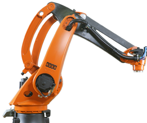
Figura 14. Robot industrial per a paletitzar KR 40 PA [Font: 26]
