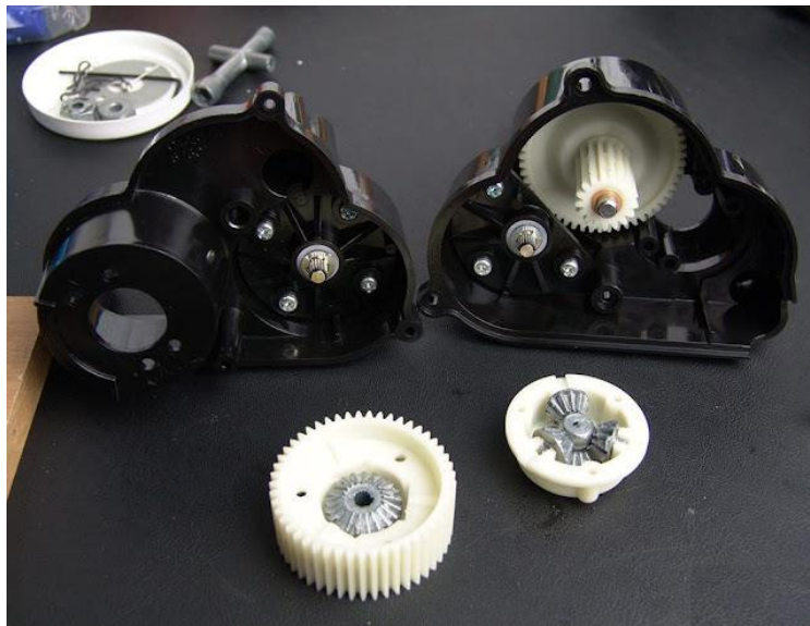
Imatge 27: Caixa d'engranatges amb diferencial [31]
