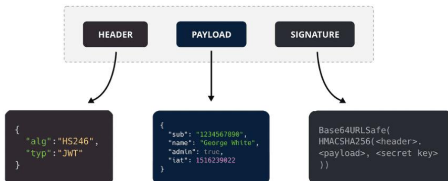
Fig. 2.39 Structure of a JSON Web Token (JWT)
