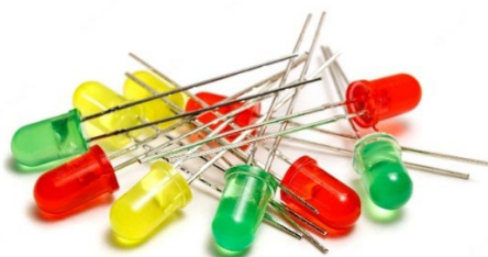
Figura 7.5.- Conjunt de LED com els utilitzats pel prototip, de diferents colors i mides. Font: (30).
