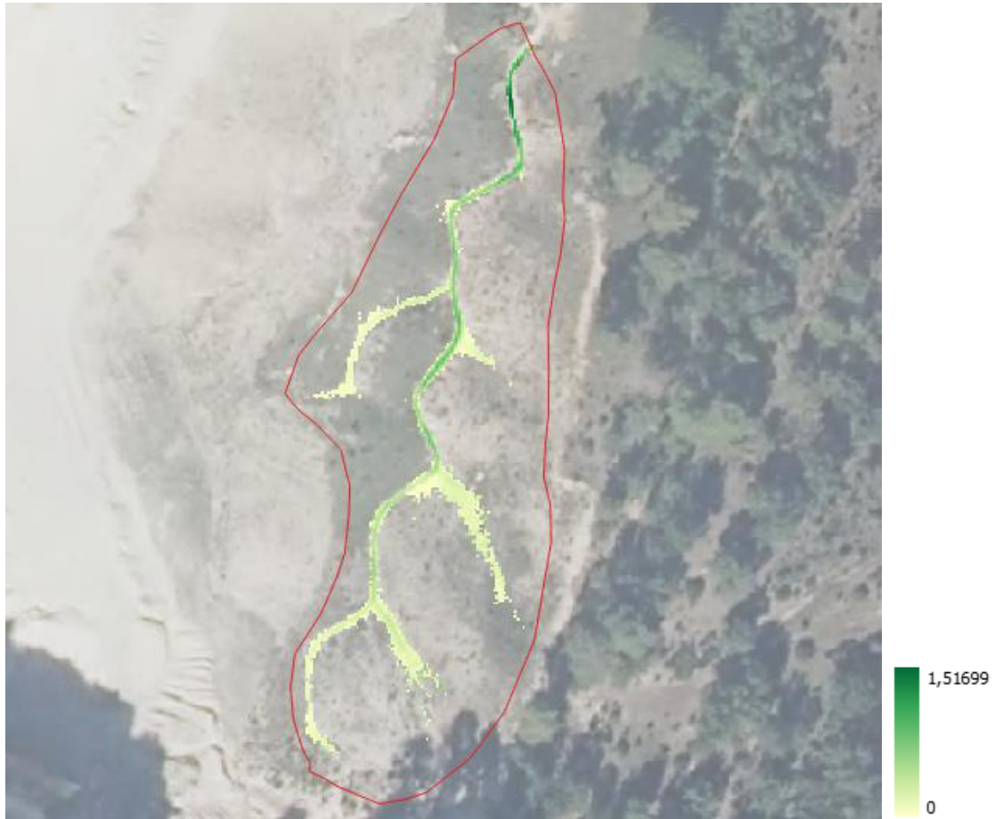
Figura 35. Erosió calculada (m) per a l'esdeveniment de 5 anys de període de retorn.
