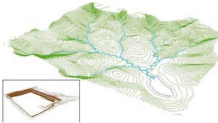
Figura 7. Relleu dissenyat amb Natural Regrade on es veuen les corbes de nivell (en verd) i la xarxa de canals principals (en blau).
