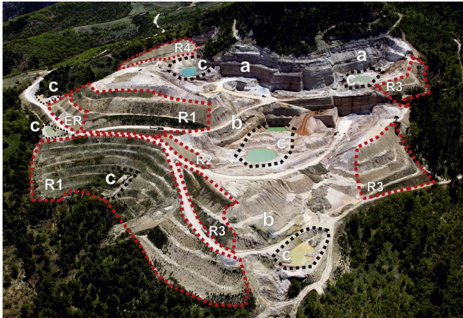
Figura 13. Foto aèria de la mina El Machorro. (a) cel obert; (b) abocador de residus no recuperats; (c), estanys; R1, R2 i R3: terrasses de col·luvions carbonatats; R4: recuperació geomòrfica mitjançant Geofluv-Natural Regrade; (ER): abocador de residus de recuperació minera experimental.
