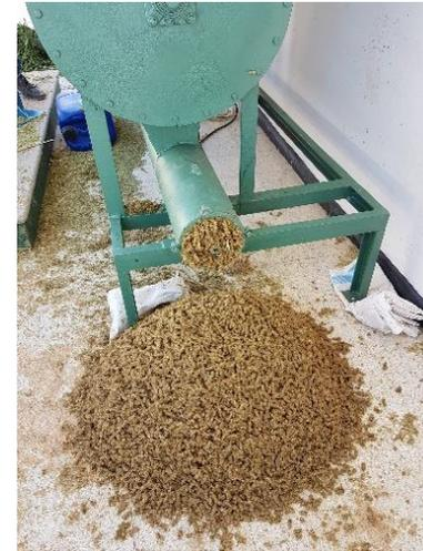
Résultat: La production des bouchons n'a pas réussi à cause du problème de séchage
