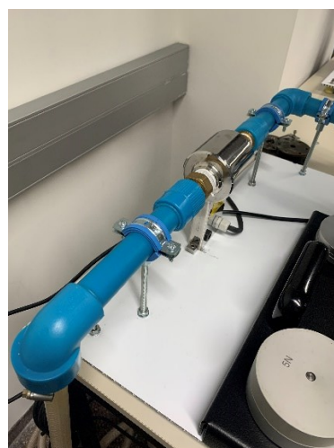
Figura 4.3. Avanç a través dels tubs i cabalímetre (Font: Oriol Rodríguez)
