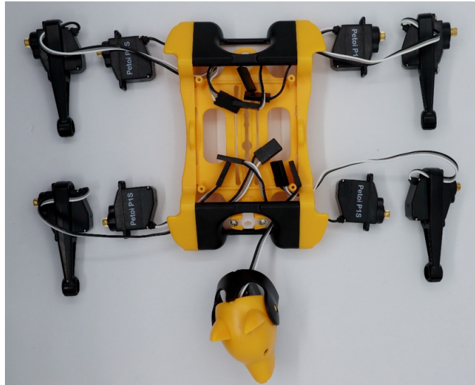
Figure 2.5.: Ensamblaje estructural del robot Bittle [44]
