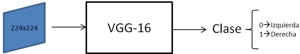
Figure 3.21.: Representación funcional del modelo VGG-16 entrenado para clasificar la posición del objetivo
