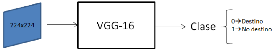
Figure 3.15.: Representación funcional del modelo VGG-16 entrenado para determinar el destino
