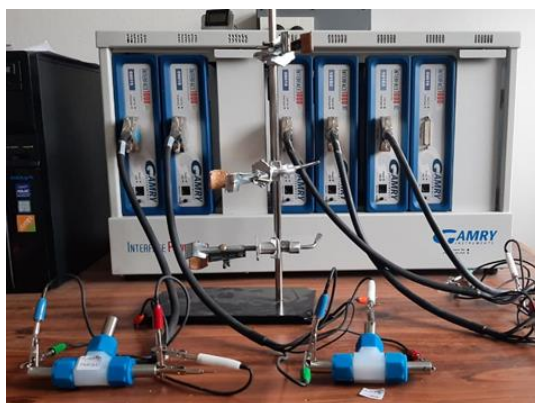
Figura 3.10. Potencióstato multicanal GAMRY interface 1000
