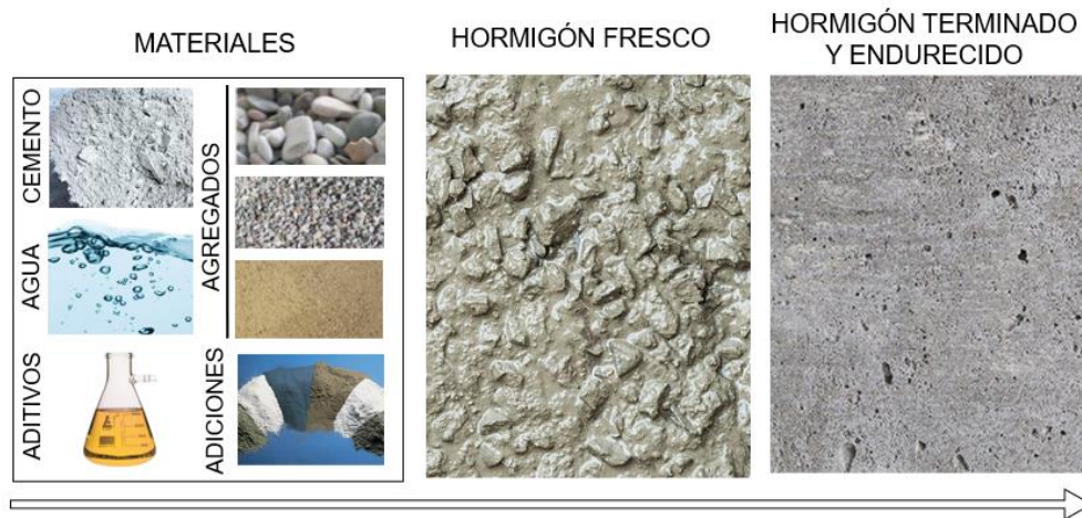
Figura 2.1 Materiales y estados del hormigón.
