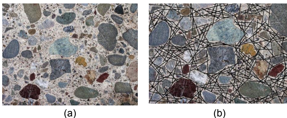
Figura 2.2. Sección transversal de (a) un hormigón simple y de (b) un hormigón reforzado con fibras de acero rectas. (Singh, 2017)
