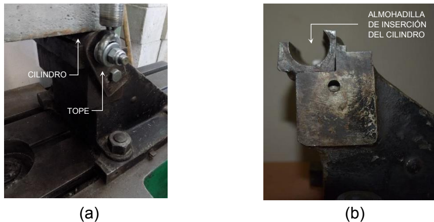
Figura 4.10 (a) Detalle del rodillo de contacto con el espécimen y (b) almohadilla de inserción del rodillo.
