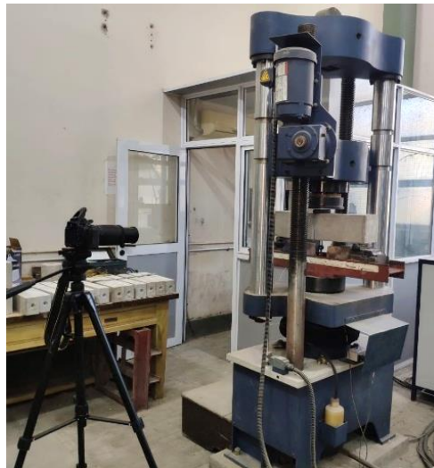
Figura A2.8 Flexión estática con cámara digital.
