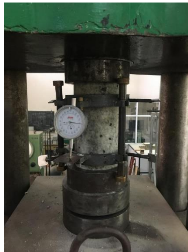
Figura 3.8 Configuración para determinación del módulo de elasticidad.
