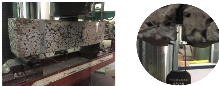
Figura A3.6 Montaje de ensayos de flexión EN 14651 en hormigones drenantes.
