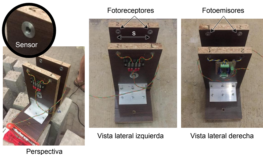
Figura A1.3 Cronógrafo balístico construido
