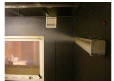
Air diffusion visualisation using fumes
