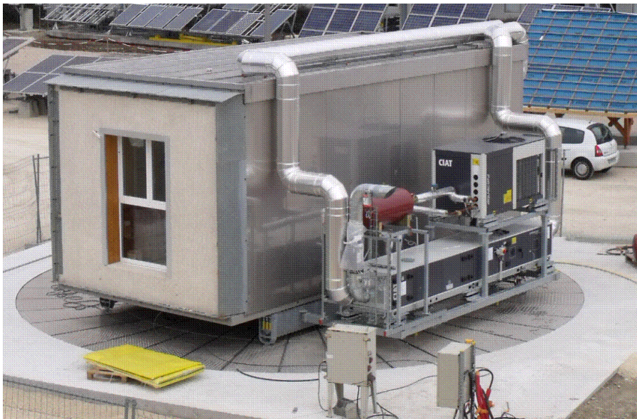
The new air handling unit.
