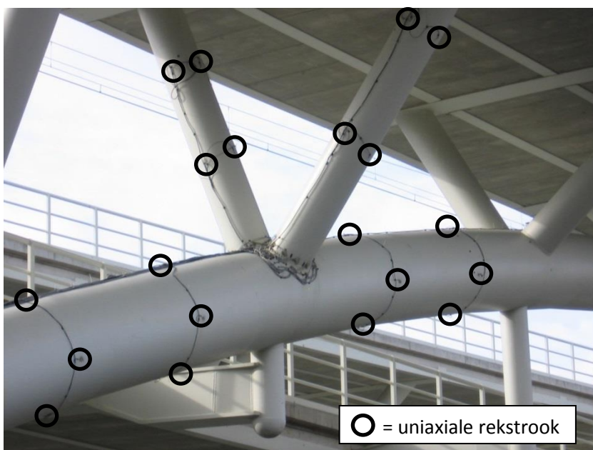
Figuur 6-17: Locatie van de rekstroken die de nominale rekken meten
