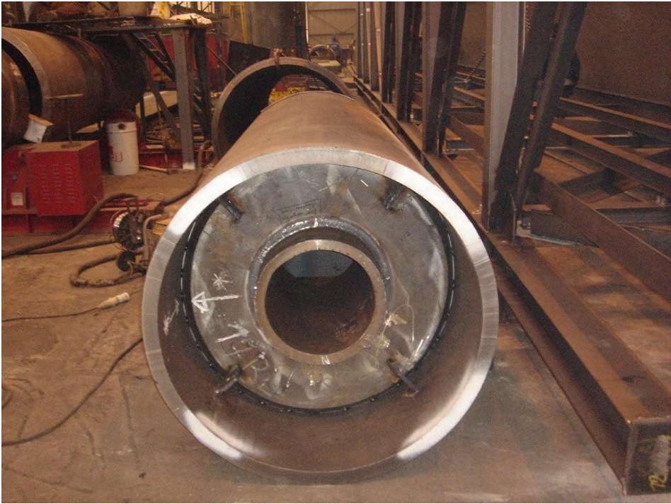
Figuur 6-7: Positionering van de diafragma's binnenin de boog
