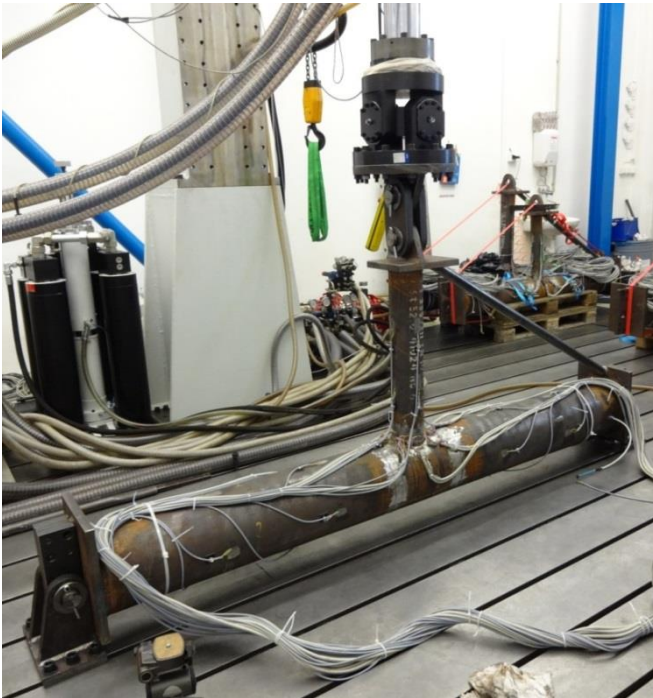
Figuur 8-7: Proefstuk 2 geplaatst in de proefopstelling
