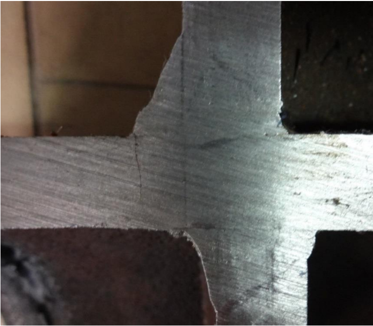
Figuur 8-40: Scheurpatroon proefstuk 3
