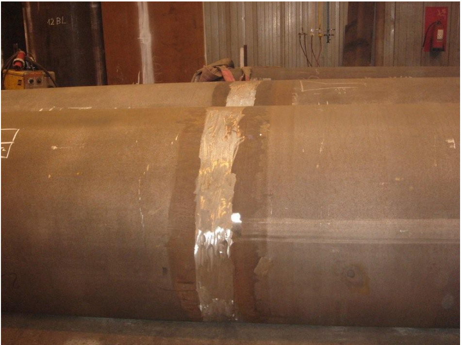
Figuur 6-5: Volledige doorlassing tussen twee moten van de boog
