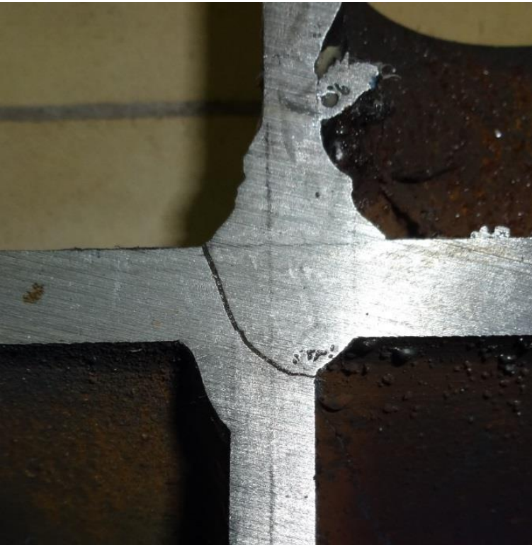
Figuur 8-43: Scheurpatroon proefstuk 6
