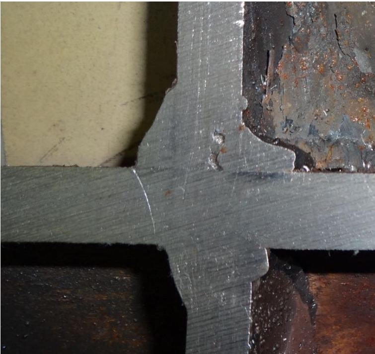
Figuur 8-41: Scheurpatroon proefstuk 5
