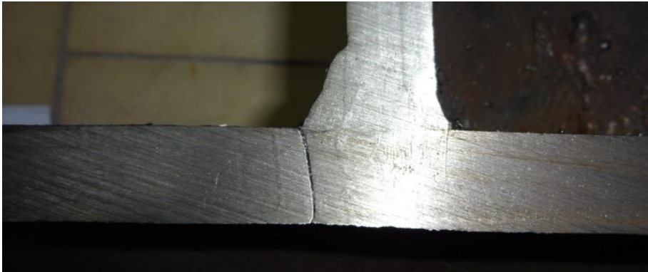
Figuur 8-38: Scheurpatroon proefstuk 1
