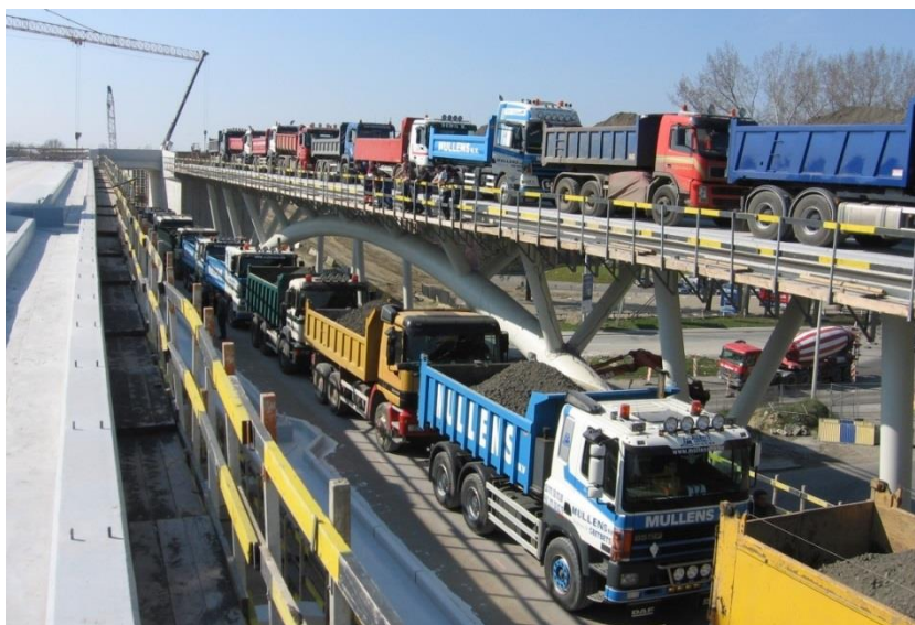
Figuur 6-19: Belastingproef met vrachtwagens (meetpositie 2)
