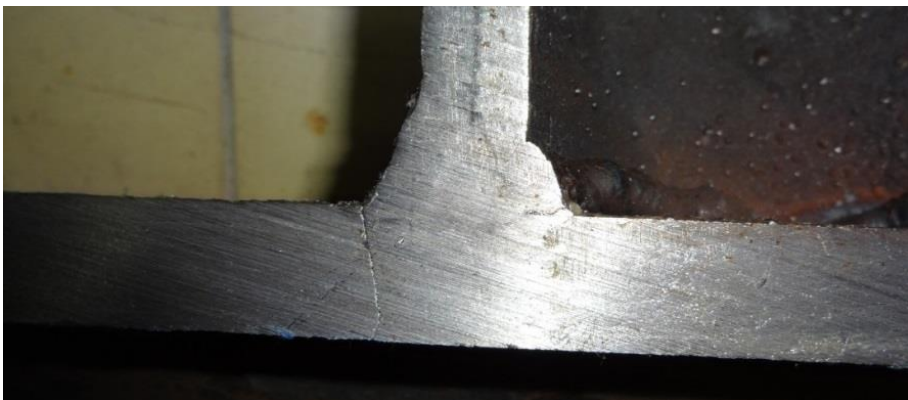
Figuur 8-39: Scheurpatroon proefstuk 4
