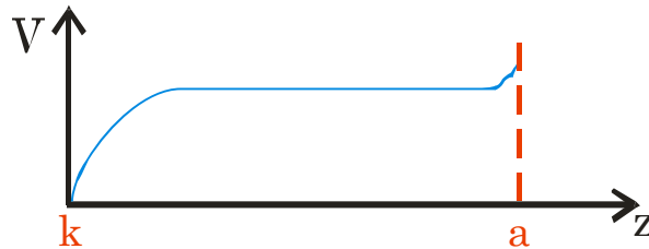
Figuur 3. Ruimtelijke evolutie van de potentiaal in een glimontlading (k = kathode, a = anode).
