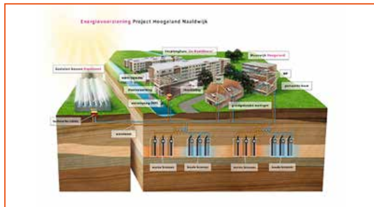
Een serre als energiepartner in woonwijk Vestia te Hoogland
