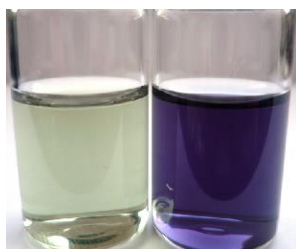
Figura II.20. Ilustración del ensayo de Kaiser para el análisis de aminas primarias en una muestra. Izquierda: disolución de control (incoloro), derecha: disolución con resultado positivo en aminas primarias (azul oscuro).
