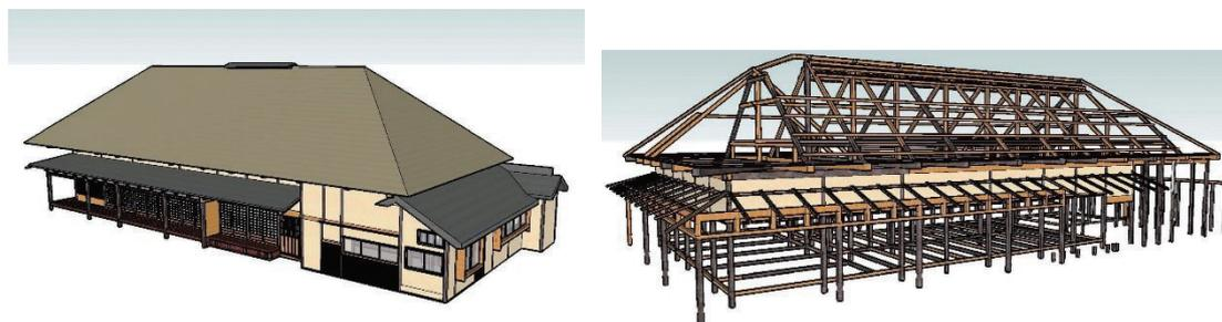
図1 岩手県指定文化財旧吉田家住宅外観と架構3Dイメージ（東北工業大学中村琢巳研究室制作）
