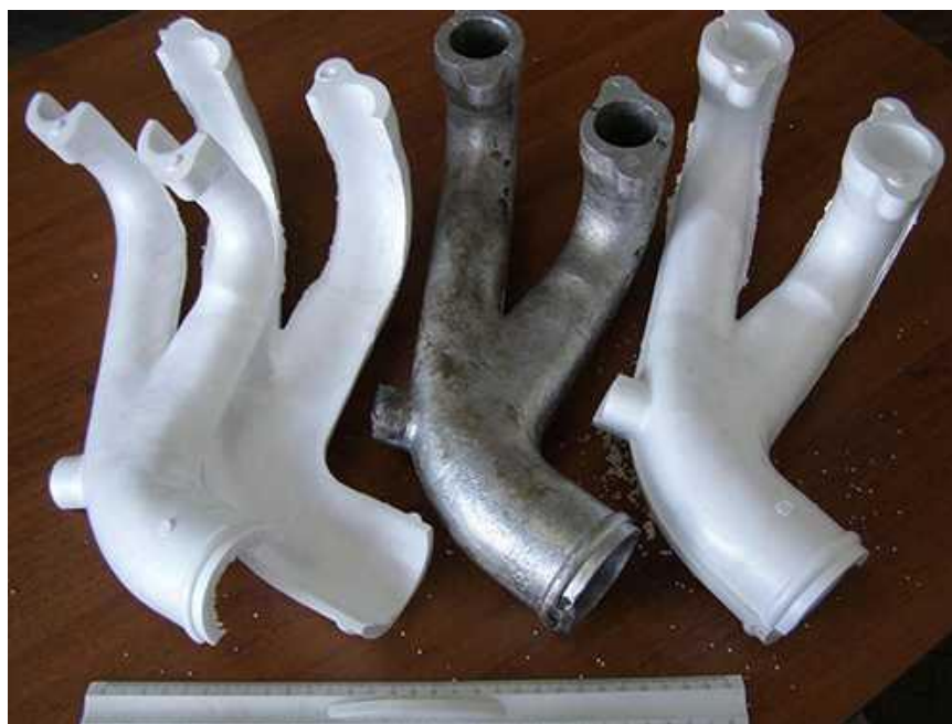
Рис 3.1.2 Пластикова модель та відлита алюмінієва деталь
