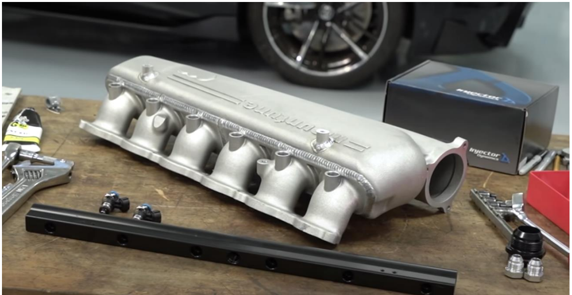
Рис. 3.2.6 Впускний колектор Paradakis Racing, надрукований на 3D принтері та зварений після.
