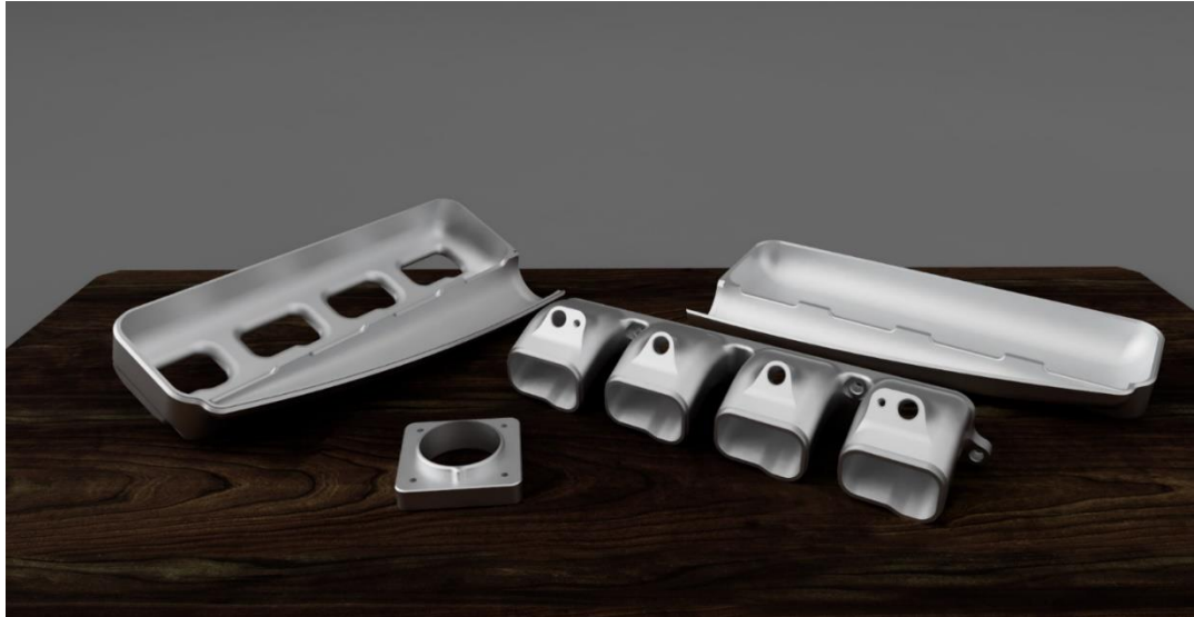
Рис 2.5.5 Фотореалістичний рендер частин колектора
