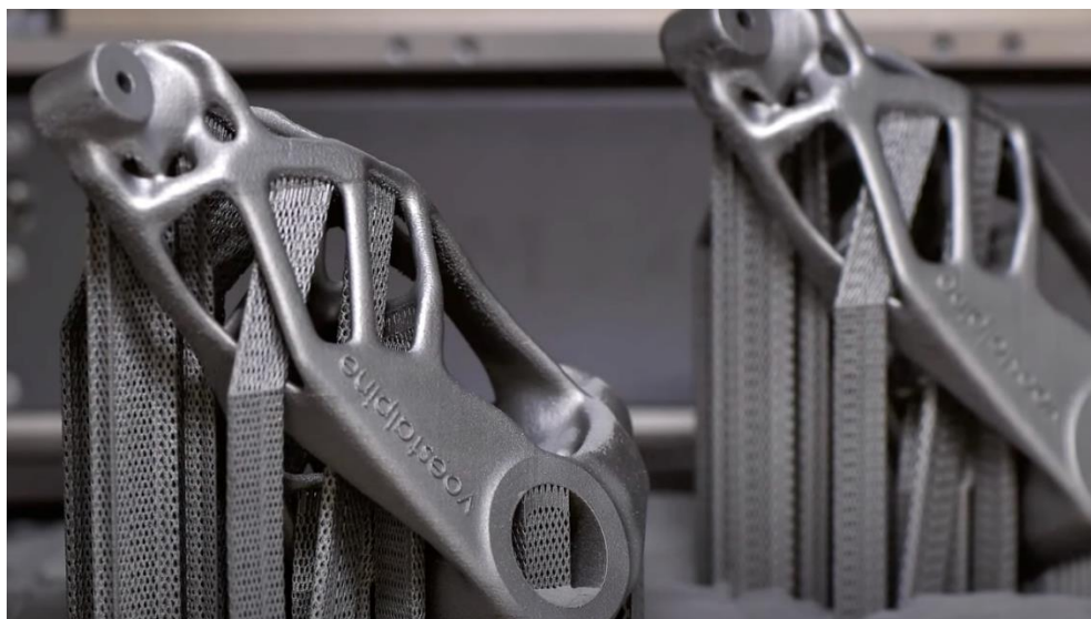
Рис. 3.2.5 Приклад надрукованої деталі із опорними конструкціями
