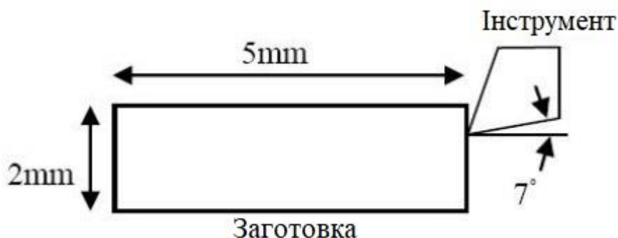
Рис. 4.2.1. Геометрія заготовки та положення інструменту
