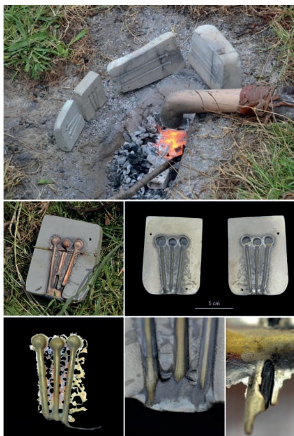
Fig. 15. Operazioni di colatura e semilavorati ottenuti.
