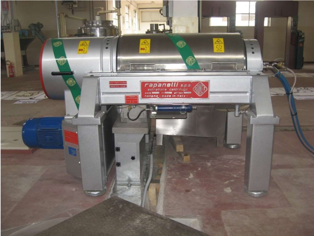
Fot. 11. Separatore centrifugo orizzontale meglio noto come Decanter (Fonte: Arnaldo Serraiocco – CREA)
