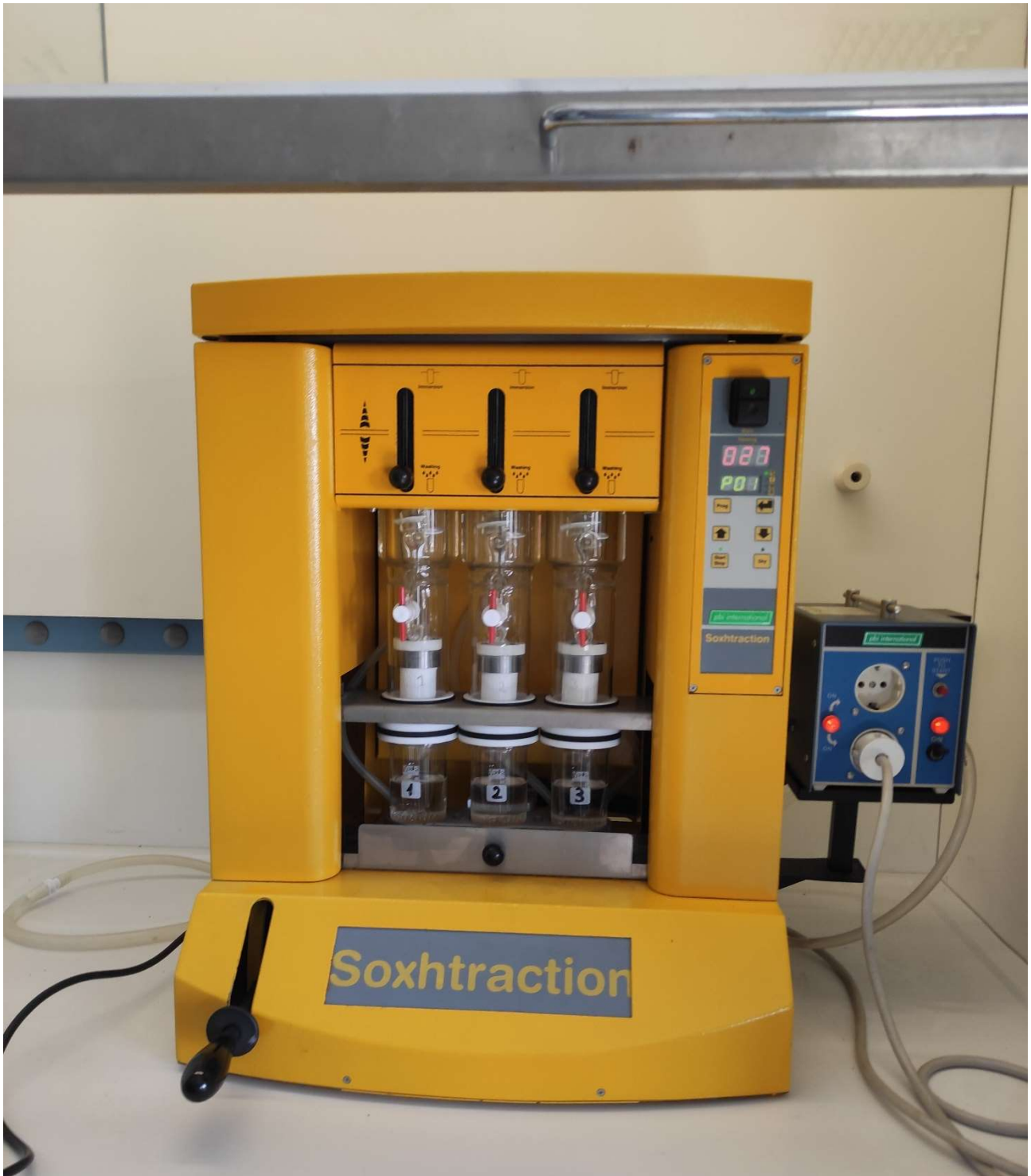
Fot. 19. Soxhtraction apparecchio per l'estrazione dei grassi attraverso il metodo Randall
