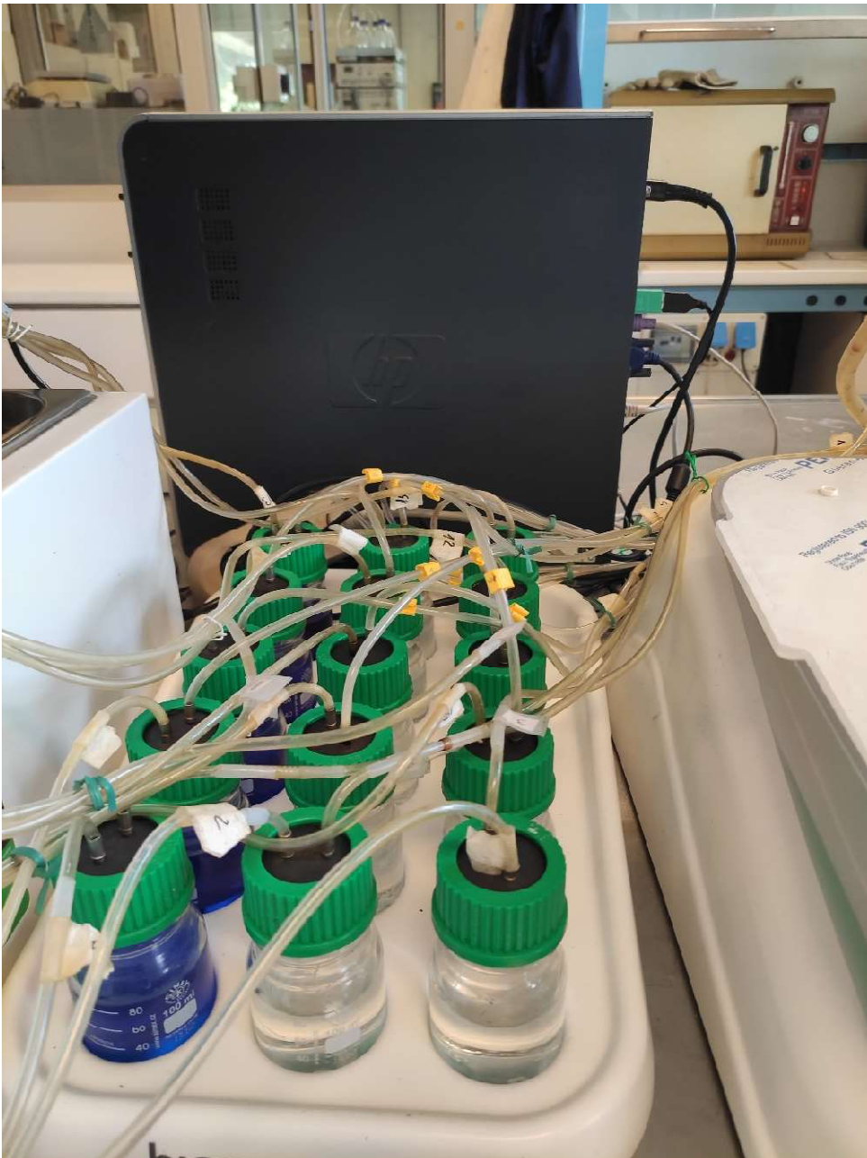
Fot. 26. Unità di assorbimento dei gas acidi dell'AMPTS II
