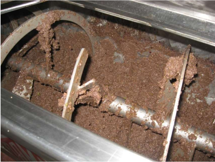
Fot. 10. Particolare dell'interno di una gramolatrice in lavorazione della pasta d'olive (Fonte: Arnaldo Serraioco – CREA)
