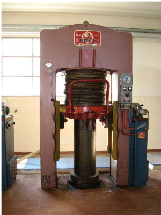
Fot. 8. Pressa con carrello e fiscoli (Fonte: Arnaldo Serraiocco – CREA)
