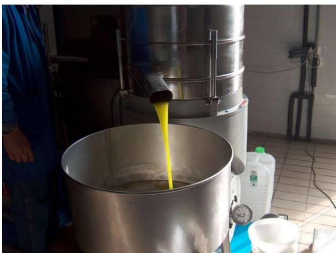
Fot. 13. Particolare dell'uscita dell'olio da un separatore centrifugo verticale (Fonte: CC BY-SA 3.0, https://commons.wikimedia.org/w/index.php?curid=1416080 )
