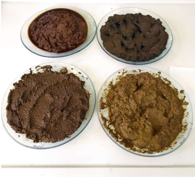
Fot. 27. SUV trattate e non trattate. Dopo i trattamenti ossidativi, si può notare la decolorazione delle sansa trattate con tenori di perossido d'idrogeno maggiori.
