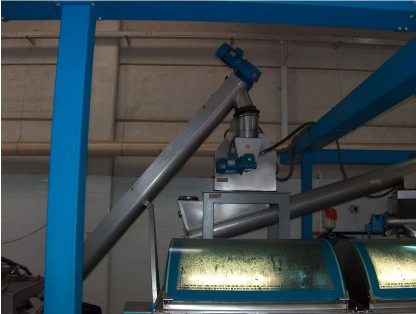
Fot. 9. Frangitore a martelli con carica dall'alto (Fonte: CC BY-SA 3.0, https://commons.wikimedia.org/w/index.php?curid=1416781 )
