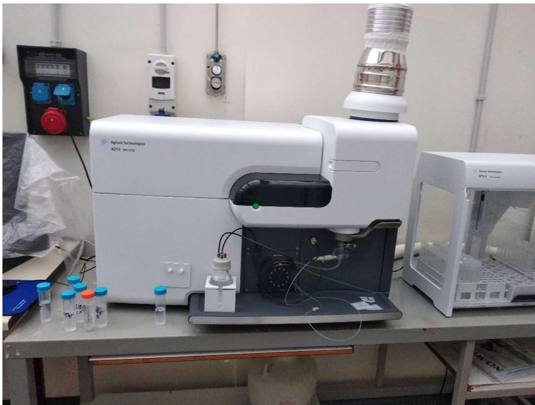
Fot. 22. Spettrometro ad emissione atomica Agilent 4210 MP-AES
