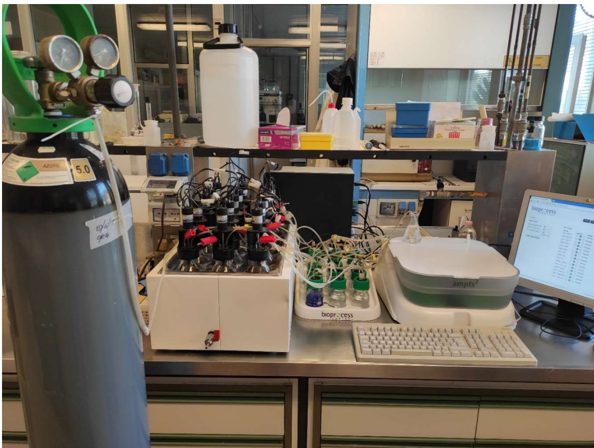
Fot. 25. AMPTS II apparato sperimentale utilizzato per la misura del BMP.
