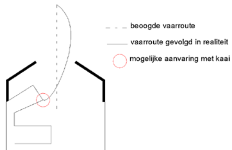
Fig. 1. Overcorrectie schip na passage door de havenmond.
