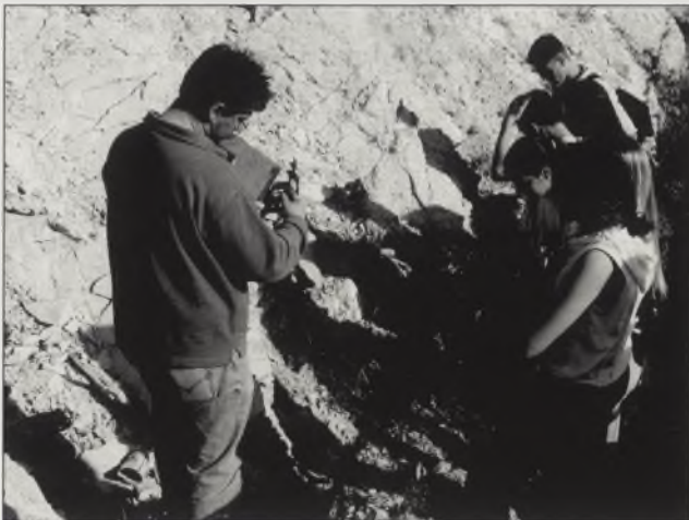
FIGURA 1. Uso de la brújula y clinómetro para la determinación de la dirección y ángulo de buzamiento de estratos presentes en el patio del IES Jorge Juan.
