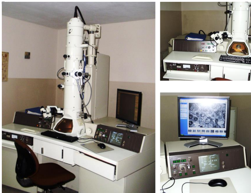
Figura 3. Microscopio electrónico de transmisión (Servicio de microscopía electrónica, FCV-UNLP). MAF y CB.
