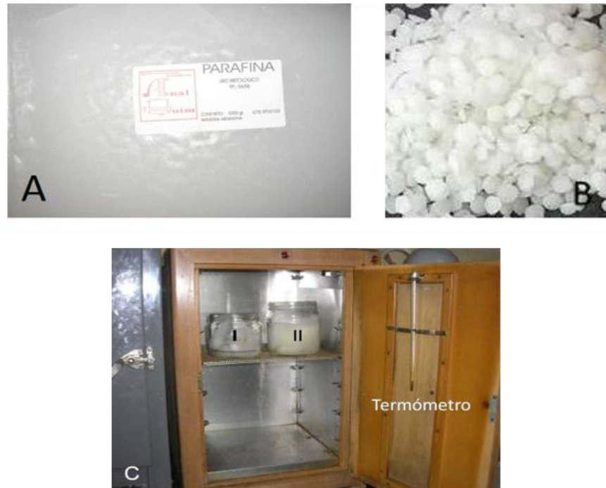
Figura 8. A. Parafina en panes. B. Parafina en perlas. C. Estufa para fundir la parafina, con dos recipientes con parafina sólida (izquierda) y semisólida (derecha). MAF.
