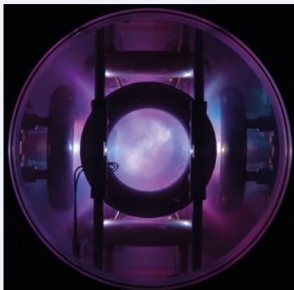
Kuva 2. EMC2:n rakentama Polywell korkean betan tutkimuksia varten. Laitteen sivun pituus on 21.6 cm (kuva: EMC2).
