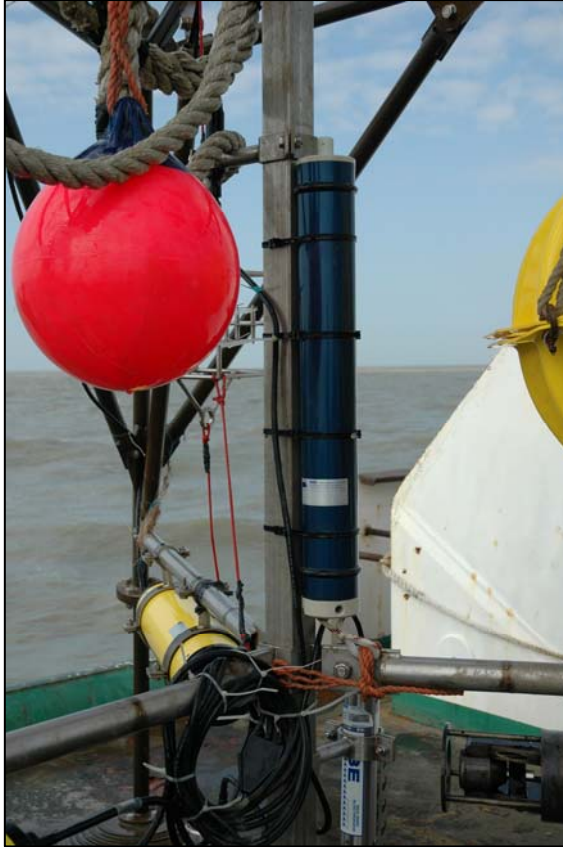
Figuur 7-14 - Detail van de bevestiging van de T-PoD aan de tripode (foto Joan Backers, KBIN/BMM).
