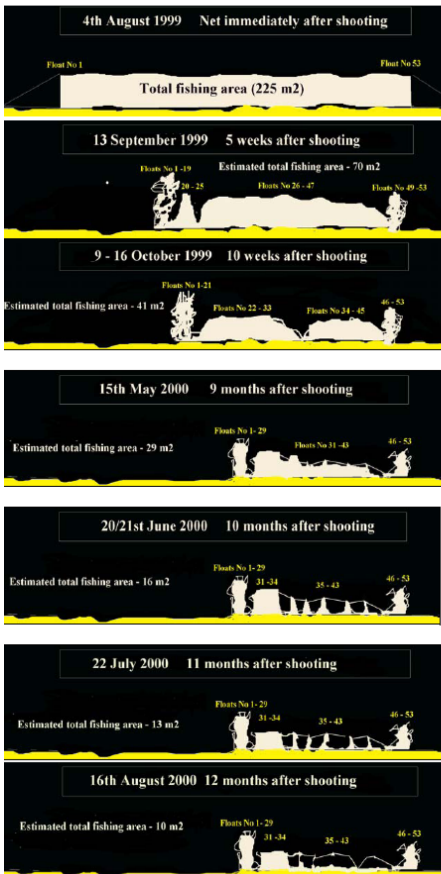
Figuur 4-6 - Fysische degradatie van het wraknet (sketches zijn gebaseerd op fysische metingen en onderwaterfilm) (Revell and Dunlin, 2003)
