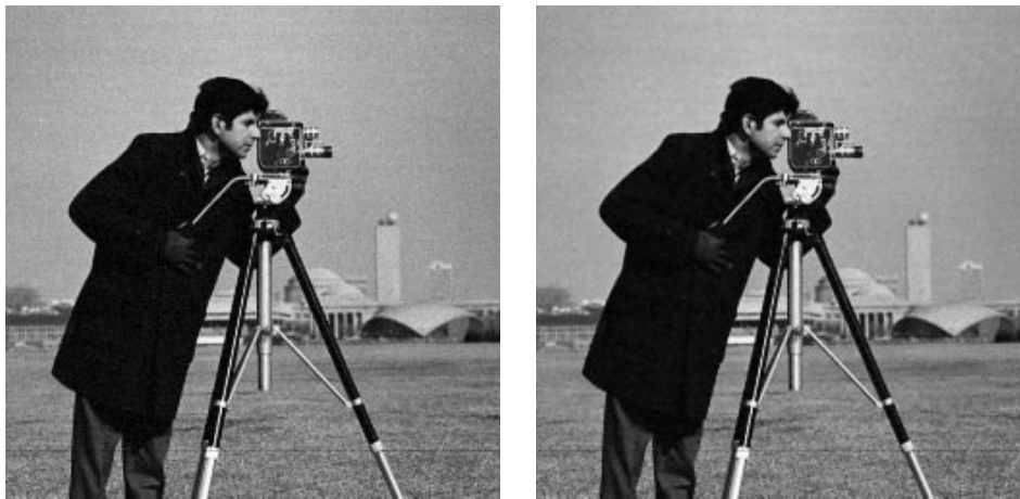
Figuur 7.11: Het “cameraman” beeld. Links: ruisbeeld met \sigma = 5 ; rechts: resultaat na filtering met de GOA filter ( \alpha = 1 , 1 iteratie).
