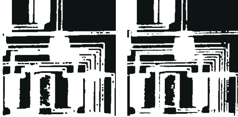
Figuur 3.4: De binaire sluiting S(A, B) (links) en de binaire opening O(A, B) (rechts). Het originele beeld A wordt voorgesteld in Figuur 3.2; het structuurelement B is hetzelfde als hoger.
