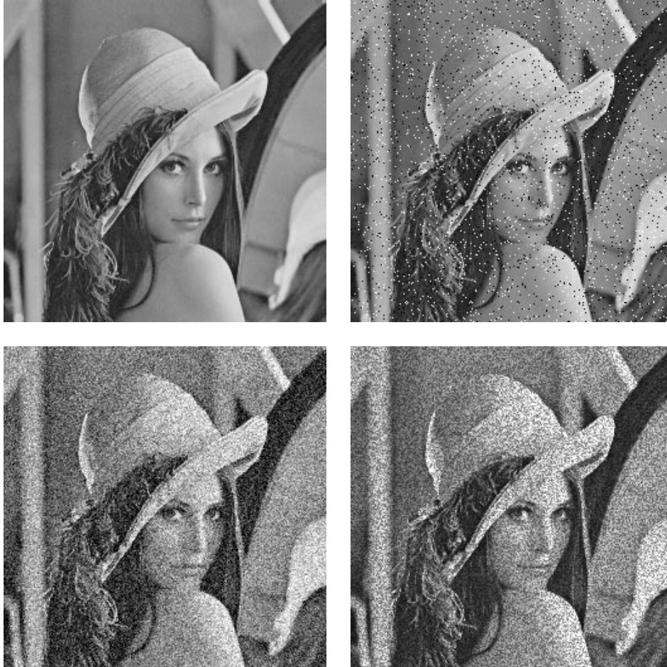
Figuur 7.1: Illustratie van de drie ruistypes. Boven links: origineel “lena” beeld; boven rechts: gecontamineerd met zout & peper ruis ( \delta = 5\% ); onder links: gecontamineerd met gaussische ruis ( \sigma = 31 ); onder rechts: gecontamineerd met spikkelruis ( \sigma = 60 ). De MSE van de ruisbeelden schommelt telkens rond de 950.
