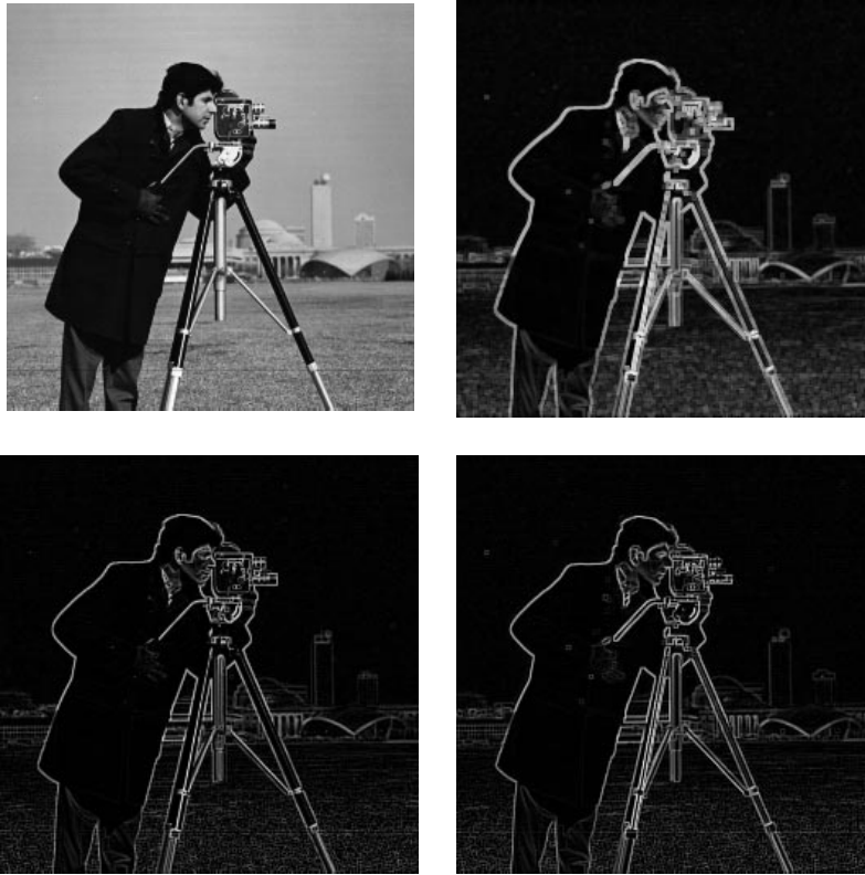
Figuur 3.13: Bovenste rij: origineel grijswaardebeeld A (links) en het resultaat van de s-morfologische gradiënt G_s^B(A) (rechts). Onderste rij: resultaat van de externe s-morfologische gradiënt G_s^{B,e}(A) (links) en de interne s-morfologische gradiënt G_s^{B,i}(A) (rechts).
