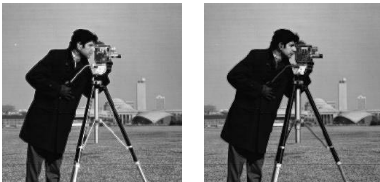
Figuur 3.16: De u-sluiting S_u(A, B) (links) en de u-opening O_u(A, B) (rechts). Het originele grijswaardebeeld A wordt weergegeven in Figuur 3.8; het grijswaarde structuurelement is hetzelfde als hoger.
