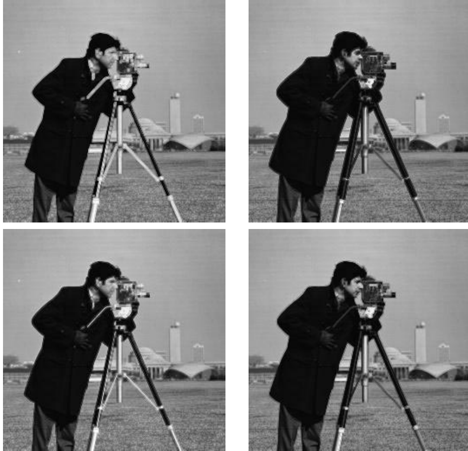
Figuur 4.3: Vaagmorfologische operatoren voor (\mathcal{C}, \mathcal{I}) = (T_w, I_w) : de dilatie D_{T_w}(A, B) (boven links), de erosie E_{I_w}(A, B) (boven rechts), de sluiting S_{T_w, I_w}(A, B) (onder links) en de opening O_{T_w, I_w}(A, B) (onder rechts). Het originele beeld A wordt weergegeven in Figuur 4.4.
