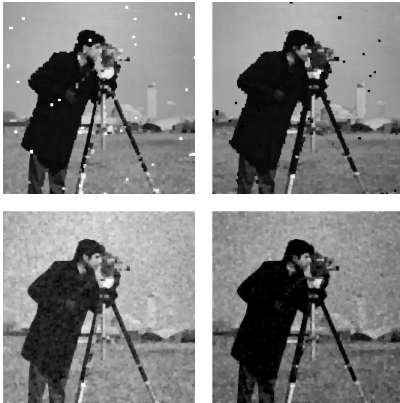
Figuur 3.12: Bovenste rij: resultaat van de s-sluiting gevolgd door de s-opening (links) en de s-opening gevolgd door de s-sluiting (rechts) op het met zout & peper ruis gecontamineerde beeld uit Figuur 3.11; Onderste rij: resultaat van de s-sluiting gevolgd door de s-opening (links) en de s-opening gevolgd door de s-sluiting (rechts) op het met gaussische ruis gecontamineerde beeld uit Figuur 3.11.
