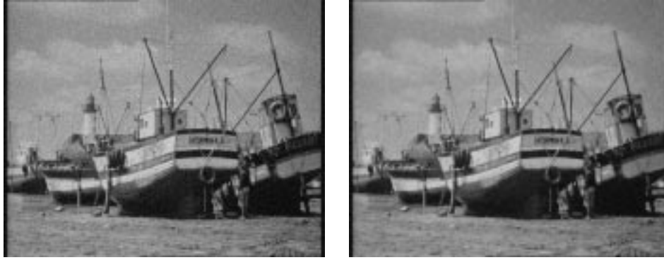
Figuur 7.12: Het “boats” beeld. Links: ruisbeeld met \sigma = 20 ; rechts: resultaat na filtering met de GOA filter ( \alpha = 2 , 4 iteraties).
