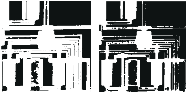
Figuur 3.3: Binaire dilatatie D(A, B) (links) en binaire erosie E(A, B) (rechts). Het origineel beeld A wordt voorgesteld in Figuur 3.2.
