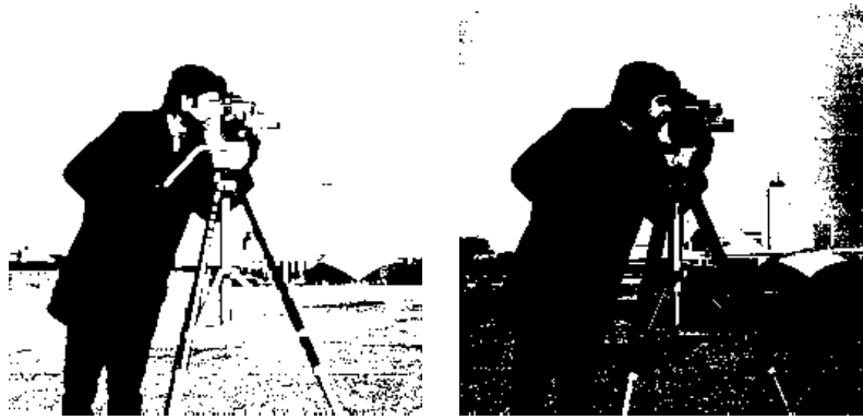
Figuur 4.5: De z-dilatatie D_z(A, B) (links) en de z-erosie E_z(A, B) (rechts). Het origineel grijs-waardebeeld A wordt voorgesteld in Figuur 3.8.
