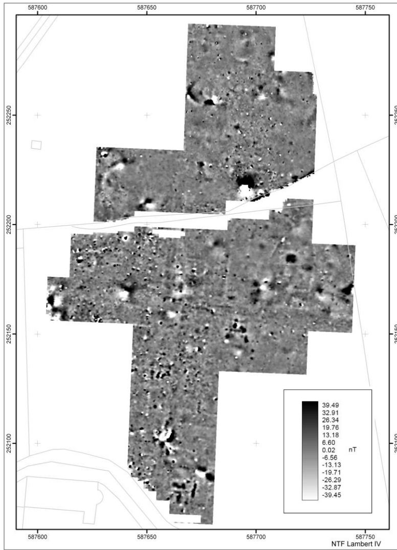
Fig. 2 Résultat des prospections magnétiques au nord de la Canonica (2006-2007). Un série de murs romains est lisible dans l'image, ainsi que divers zones d'activités de forges.
