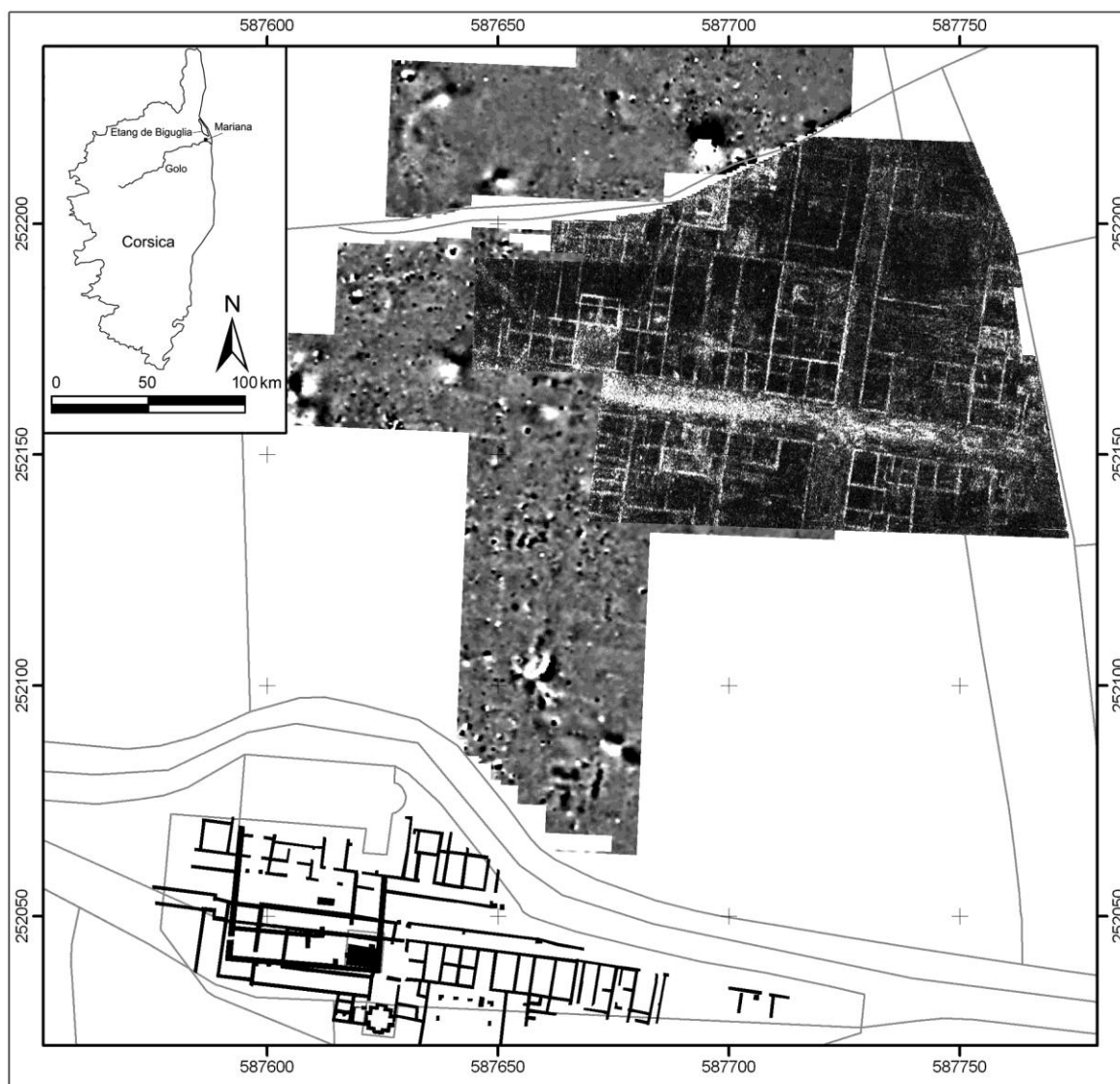
Fig. 4 Résultats des prospections radar sol 2007 et 2008 (couche avec profondeur 0,8-0,85 m), au-dessus des résultats de la prospection magnétique de 2006. Les fouilles autour de la Canonica sont indiquées en noir (en bas).
