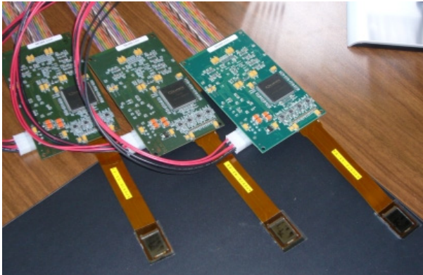
Figuur C.6: De modi-borden met LCOS panelen
