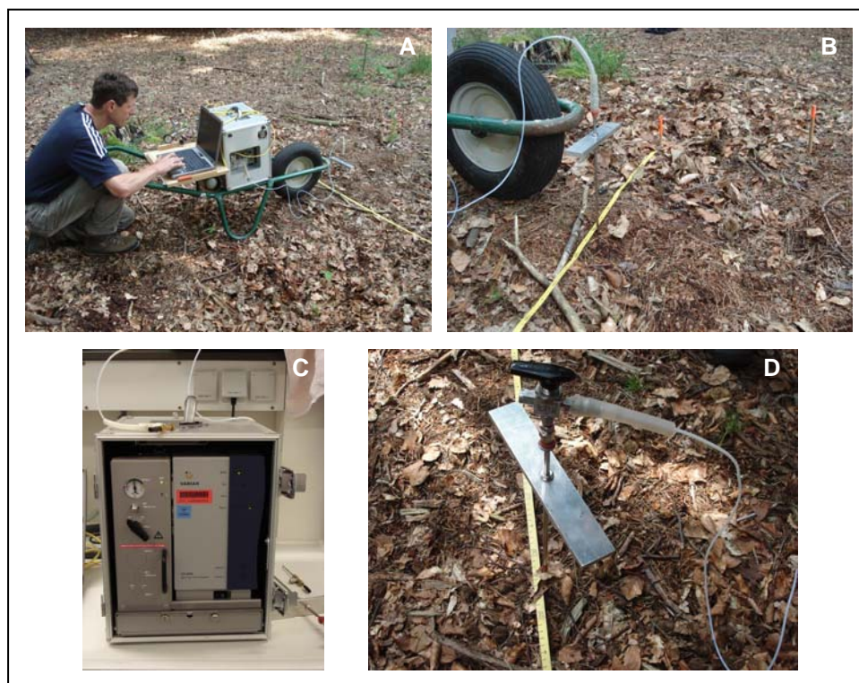
Figuur 2.1.20 Methodiek voor het bepalen van de CO 2 -concentratie in de bodem (A = overzicht opstelling, B, C en D = detail meetsonde en gaschromatograaf)
