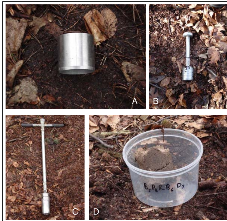
Figuur 2.1.15 Methodiek voor het bepalen van de bulkdensiteit (A = Kopeckeyring, B = grondboor voor bodemstaal in diepte 0-10 cm, C = grondboor voor bodemstalen in diepere intervallen, D = gelabeld potje voor bodemstaal)
