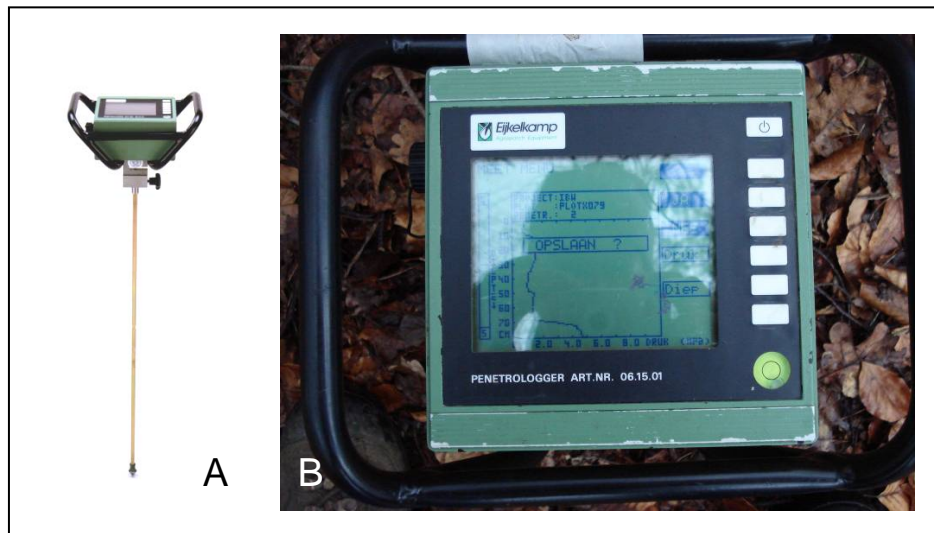
Figuur 2.1.16 Methodiek voor het bepalen van de indringingsweerstand (A = penetrometer, B = detail penetrometer: beeldscherm)
