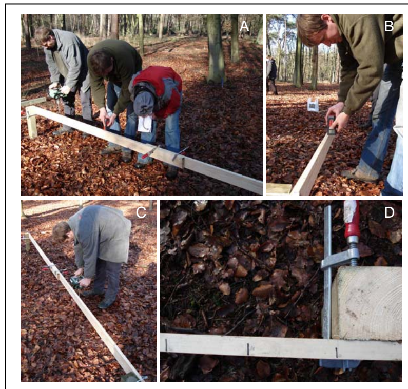
Figuur 2.1.19 Methodiek voor het bepalen van het microreliëf (A = overzicht, B = opmeten instulping, C = opmeten indringingsweerstand, D = detail constructie)
