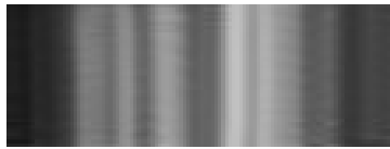
Fig. I.6 (identiek aan Fig. VII.B_4): Er worden Schlierenfoto’s gemaakt van de gereflecteerde bundel. Deze figuur geeft een uitvergroot beeld weer van de bundel. De voortplantingsrichting van het geluid op deze foto is parallel met de verticale as, terwijl de horizontale as overeenstemt met de breedterichting van de bundel. Door de ruimtelijke inhomogeniteit van de reflectiecoëfficiënt, kan Schlierenfotografie, onder de juiste omstandigheden, een franjepatroon tonen in de gereflecteerde bundel. Deze informatie is eenvoudig bruikbaar om de vezelrichting te bepalen.
