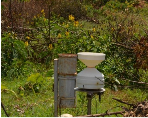
ምስል 2:- በዋንዛዬ አካባቢ የተተክለ ማኑዋል የዝናብ መለኪያ ሜትር እና ኢ+ የዝናብ መለኪያ መሳሪያ
