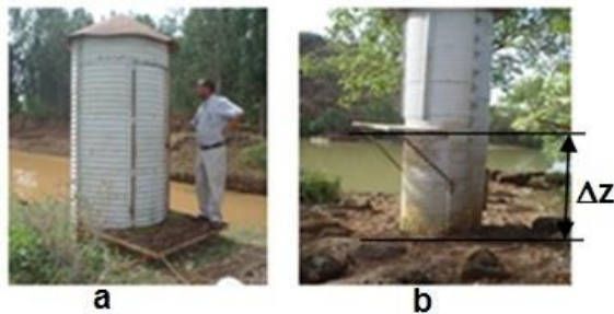
ምስል 6:- በ1959 ዓ.ም እ.ኤ.አ በዩኤስቢ.አር የተተከሉ ኦቶማቲክ የውሃ መጠን መለኪያዎች፤ ፎቶግራፉ ከደለላማው የጉማራ ወንዝ (ሀ). 11.838408 ዲግሪ ሰሜን እና 37.637086 ዲግሪ ምስራቅ) ጋር የተነሳው በ2012 ዓ.ም፤ እና ከጨረጨራ ግድብ 4 ኪ.ሜትር ርቀት የሚገኘው የዓባይ ወንዝ፤ (ለ)11.567543°N, 37.403952°E). Δz የሚያመለክተው በጉማራ ተፈጥሯዊ ወለል ላይ ከ53 ዓመታት ወዲህ ያለውን የደለል ጥልቀት ነው። (ይህም 140 ሳ.ሜ ነው፤ ከአባተ እና ሌሎች (2015 በኋላ))
