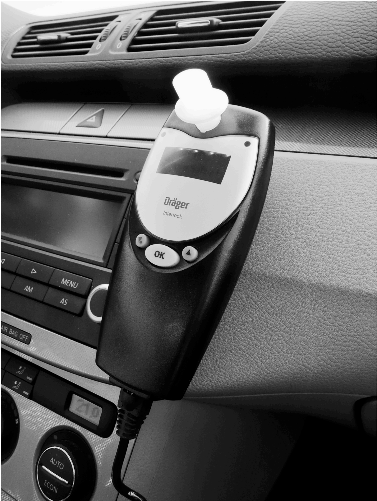
Figuur 2: Voorbeeld van een alcoholslot geïnstalleerd in een voertuig.
