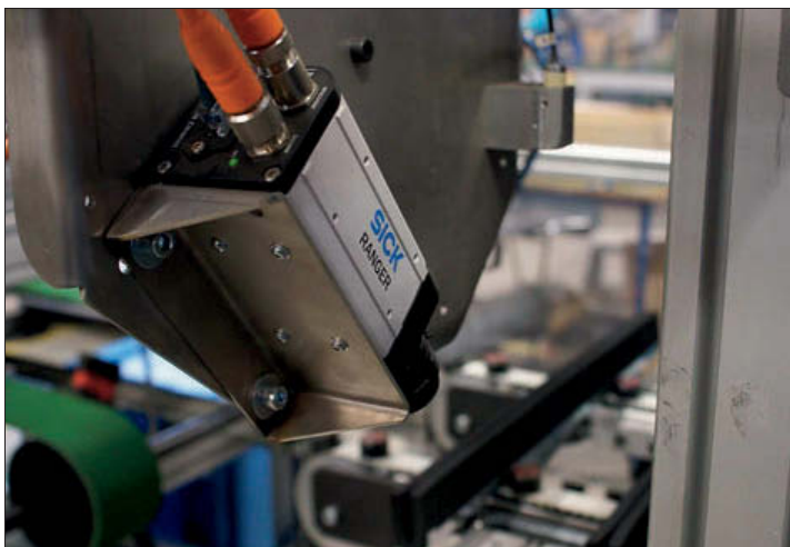
Het sluitstuk in de automatisering is een 3D-camera die elke geproduceerde vloerwisser visueel inspecteert
