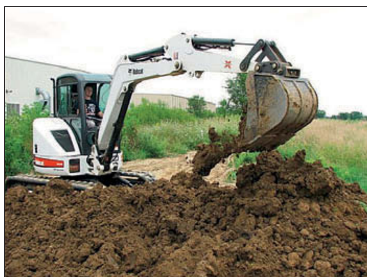
Een kleine graafkraan van het MAHA Fluid Power Lab (van de Purdue University USA) demonstreerde in 2008 tot 50% energiebesparing. De technologie (debietcontrole door pompen met variabel slagvolume) elimineert smoringsverliezen en opent ook de deur voor hybride aandrijvingen en dieselmanagement, dankzij de mogelijkheid om in vier kwadranten te werken
