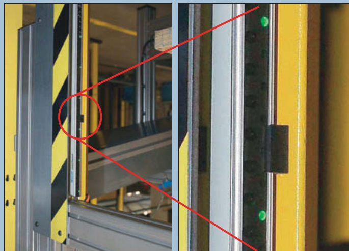
De ledlampjes geven de operator onmiddellijk een indicatie van de toestand van het veiligheidslichtgordijn
