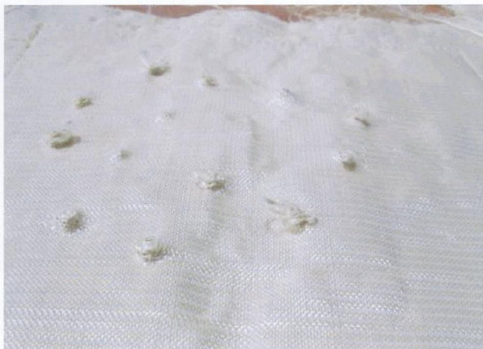
Beschädigtes Gewebe nach dem Beschuss durch Norm-Splitter [Abschlussbericht Multirapier Fachhochschule Ghent]
