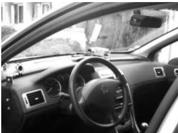
In de twee prototypes van Lavia gebeurt de dataverzameling zowel via videocamera als via elektronische dataopslag.
