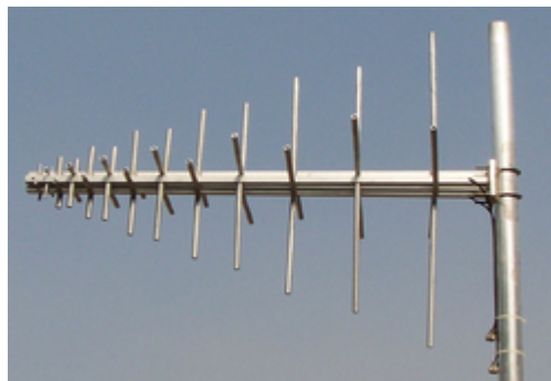
Figuur 5-9: Voorbeeld van een antenne met duale lineaire polarisatie
