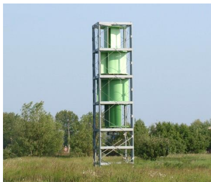
Figuur 37. principe Savonius-windturbine; prototype in het SWT Field Lab van UGent
