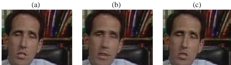
Figuur 4.5: Fragment uit een testsequentie. (a) Originele progressieve versie. (b) Temporale dichtste-buur-interpolatie. (c) Spatiale dichtste-buur-interpolatie.
